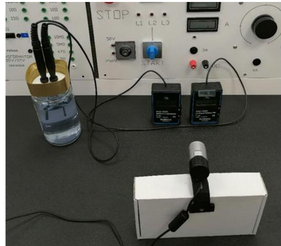
Slika 9.2 Prikazan je mjerni sklop kojeg čine termometar s otpornim temperaturnim senzorom, posuda s vodom i kamera
