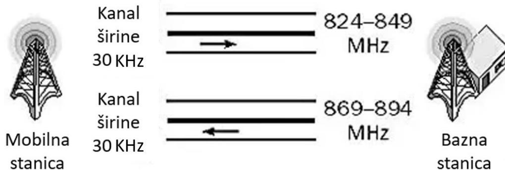
*Slika 2.2. Višestruki pristup s podjelom frekvencije (FDMA) [6]*
