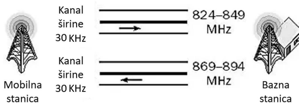
Slika 2.2. Višestruki pristup s podjelom frekvencije (FDMA) [6]
