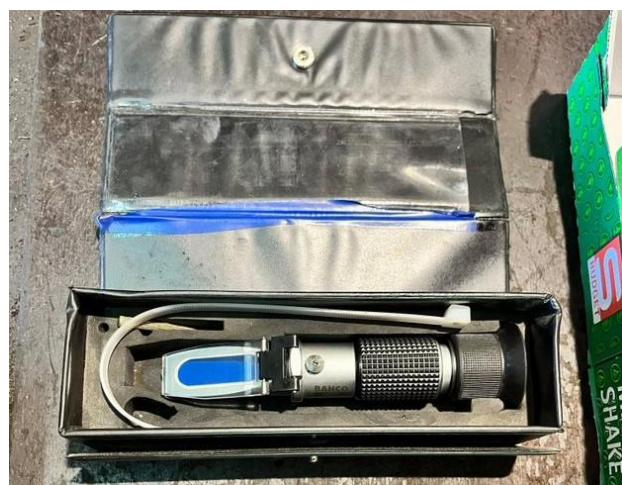
**Slika 6.2.** Refraktometar BAHCO 3046-REF
