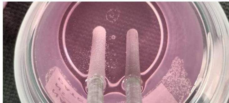
**Slika 6.8.** Prikaz redoks reakcija na aluminijskim elektrodama
