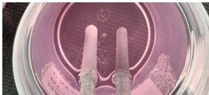
Slika 6.8. Prikaz redoks reakcija na aluminijskim elektrodama
