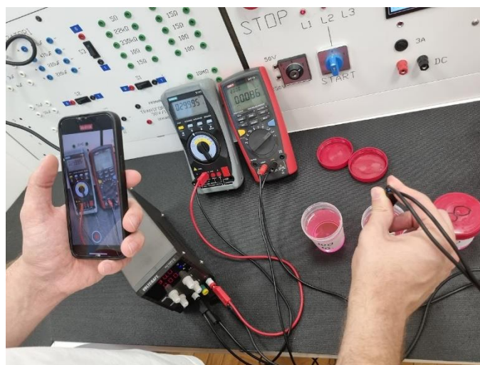
Slika 6.11. Proces mjerenja i bilježenja vrijednosti struje očitanih ampermetrom
