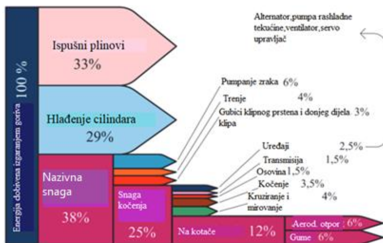
Slika 5.2. Energetska bilanca motora s unutrašnjim izgaranjem, izvor [25]
