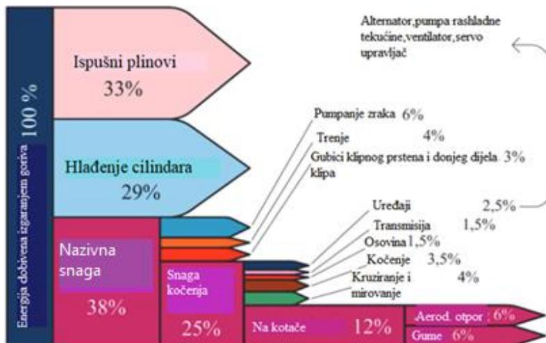
Slika 5.2. Energetska bilanca motora s unutrašnjim izgaranjem, izvor [25]
