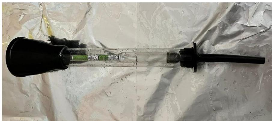
**Slika 6.4.** Hidrometar s plovkom
