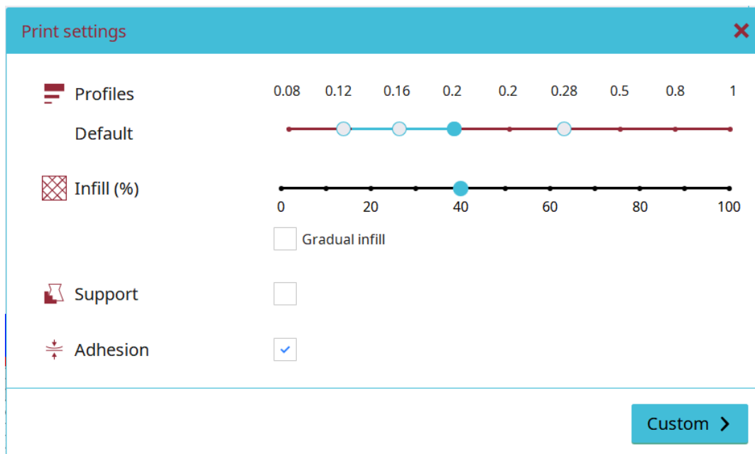
Slika 4.7. Prikaz postavki za ispis u aplikaciji Creality Slicer
