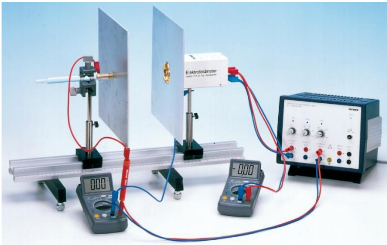
Slika 3.3. Primjer kalibracije uređaja EFM 11500-20 [10]
