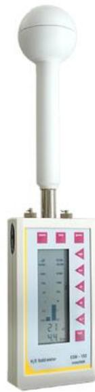
**Slika 4.1.** Mjerač električnih i magnetskih polja Maschek ESM-100 [16]
