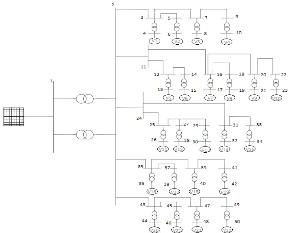
Slika 5.1. Shematski prikaz modela korištene mreže VP-a [1]
