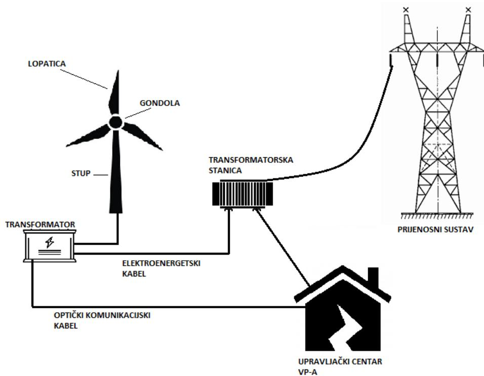
Slika 4.1. Shematski prikaz spajanja VE na prijenosnu mrežu [20]
