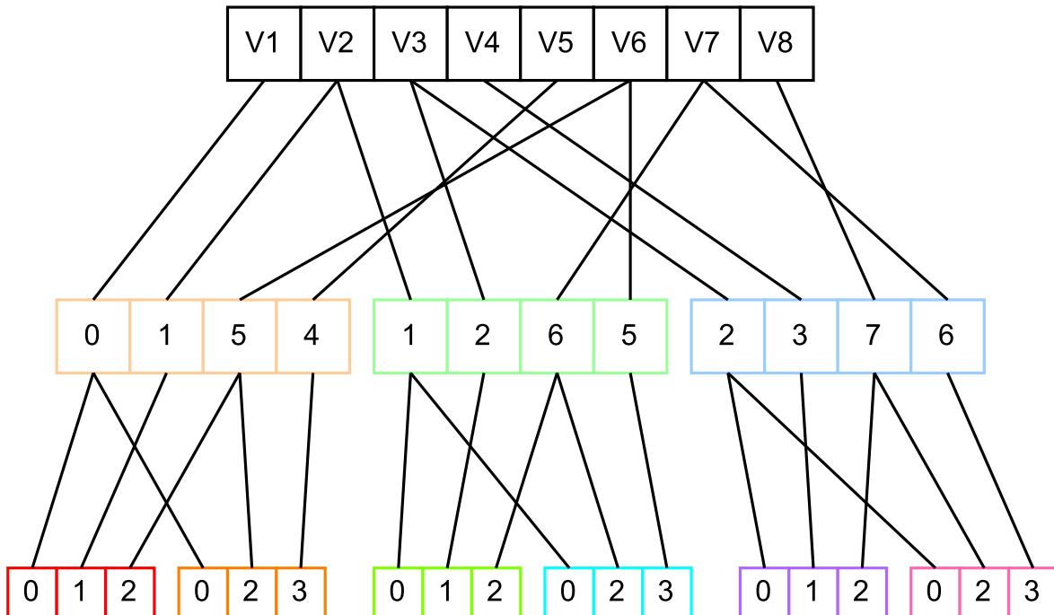
Slika 4.3 Vizualni prikaz indeksiranja buffersa sa mesh shaderima
