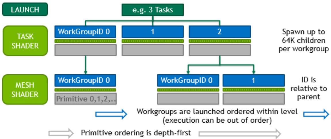
Slika 4.5 Prikaz strukture pokretanja task i mesh shadera [2]
