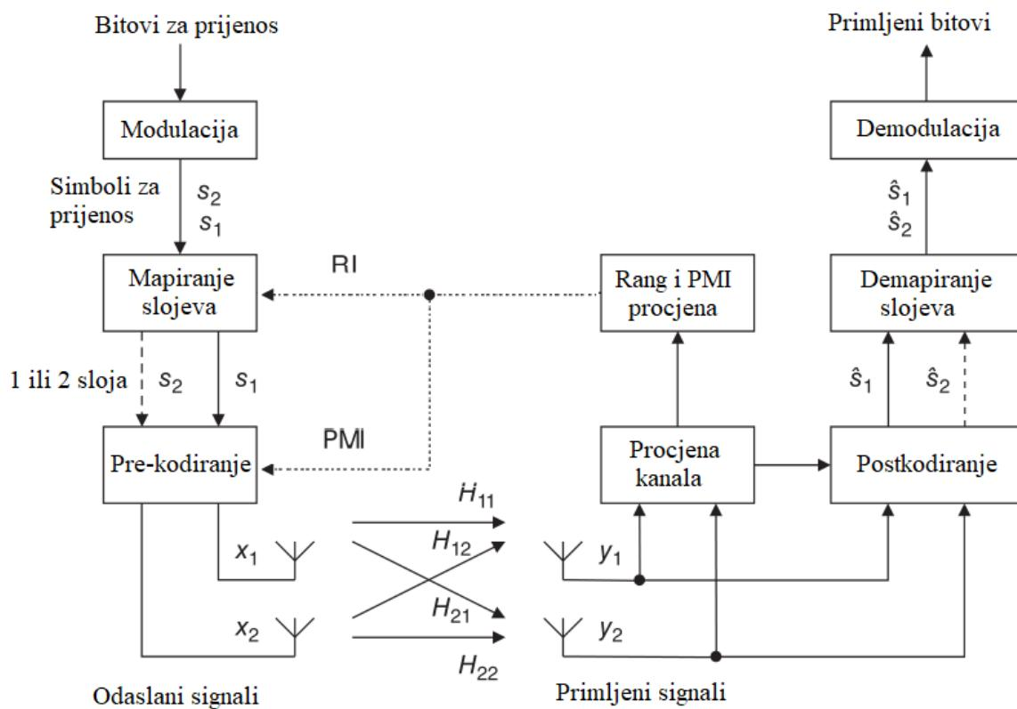
Slika 2.27. Rad sustava prostornog multipleksiranja  $2 \times 2$  zatvorene petlje [7]
