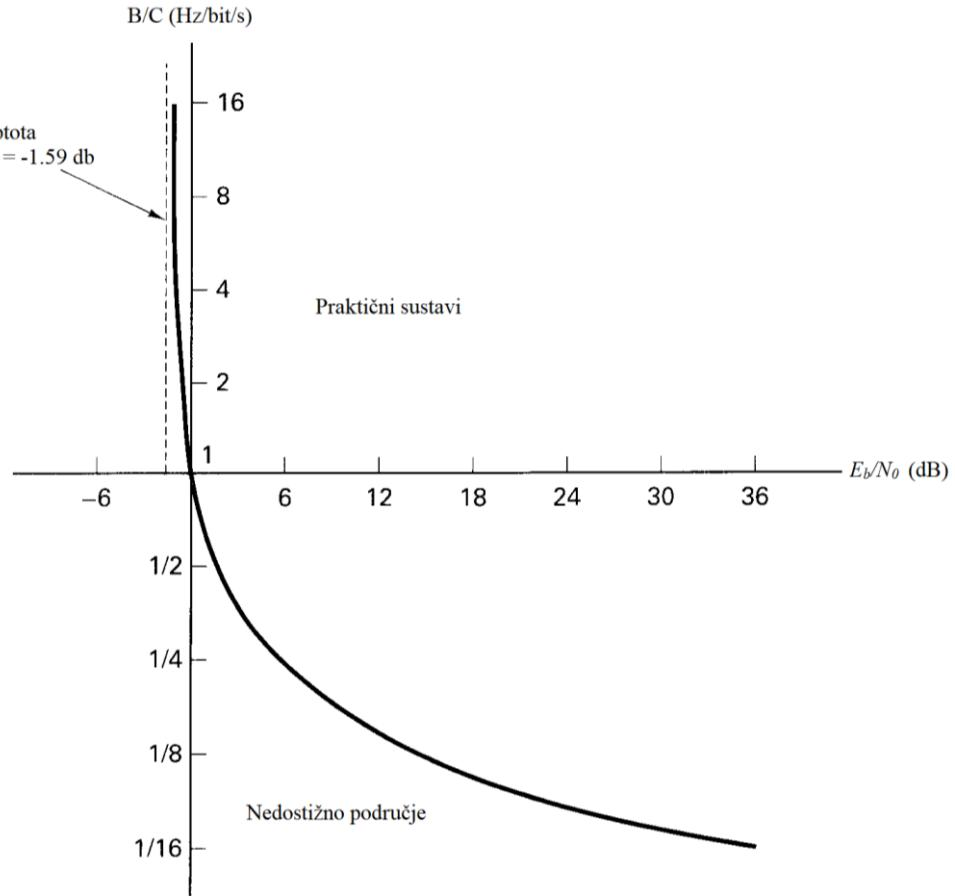
**Slika 4.4.** Normalizirana propusnost kanala u odnosu na kanal  $E_b/N_0$
