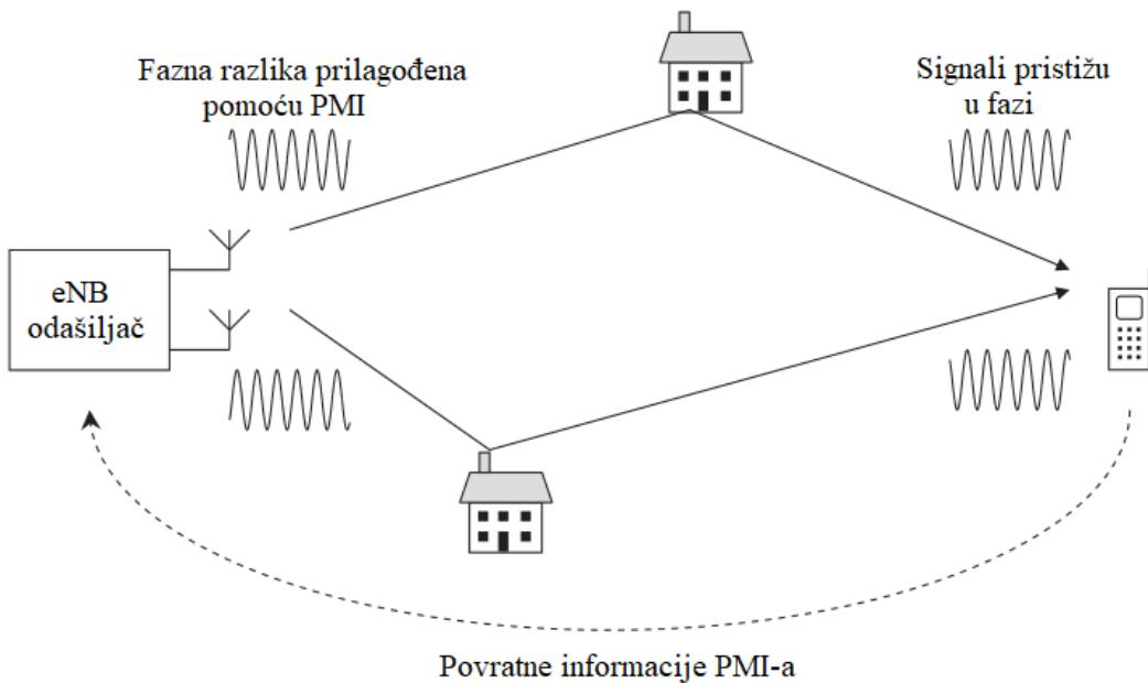
Slika 2.23. Princip rada zatvorene petlje višestrukog prijenosa [7]
