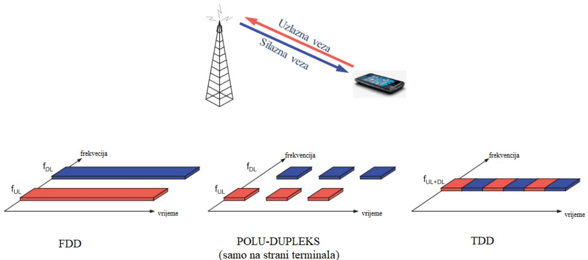
**Slika 2.1.** Dupleks s frekvencijskom i vremenskom podjelom [2]
