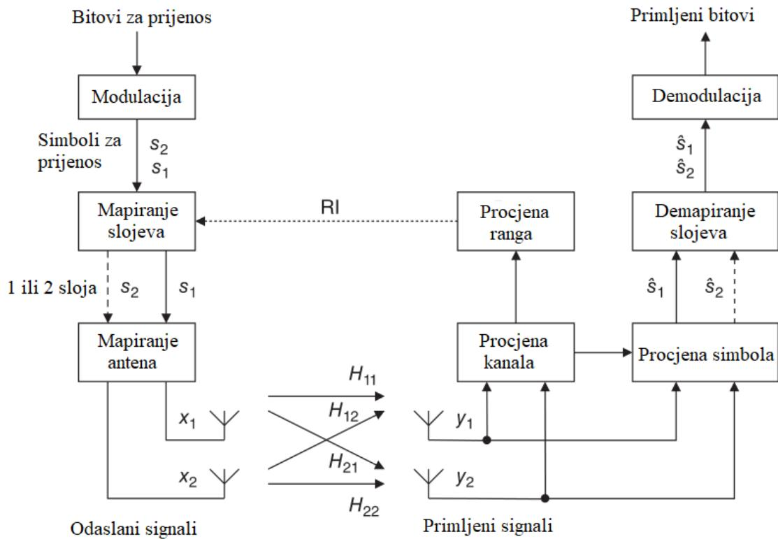
**Slika 2.26.** Rad sustava prostornog multipleksiranja  $2 \times 2$  otvorene petlje [7]
