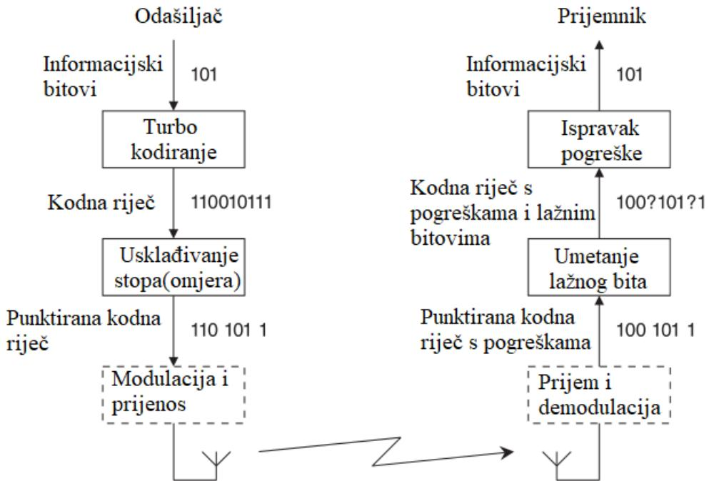
Slika 2.19. Blok dijagram odašiljača i prijamnika koji upotrebljavaju FEC i usklađuju brzine [7]
