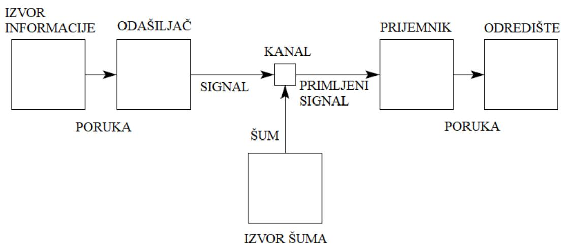
Slika 4.1. Shematski dijagram općeg komunikacijskog sustava [18]
