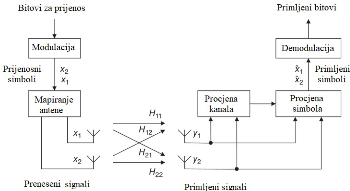
Slika 2.25. Osnovni principi  $2 \times 2$  sustava prostornog multipleksiranja [7]
