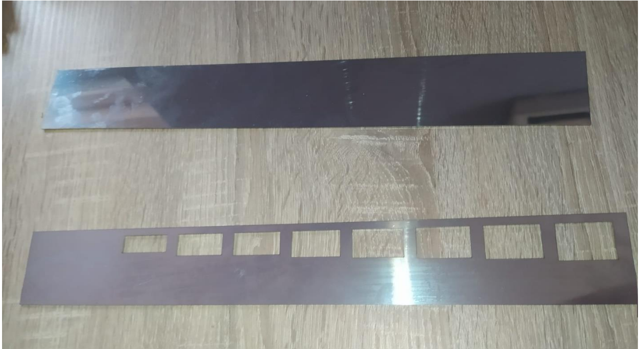
Slika 3.5. Metalne pločice izrezane CNC strojem.
