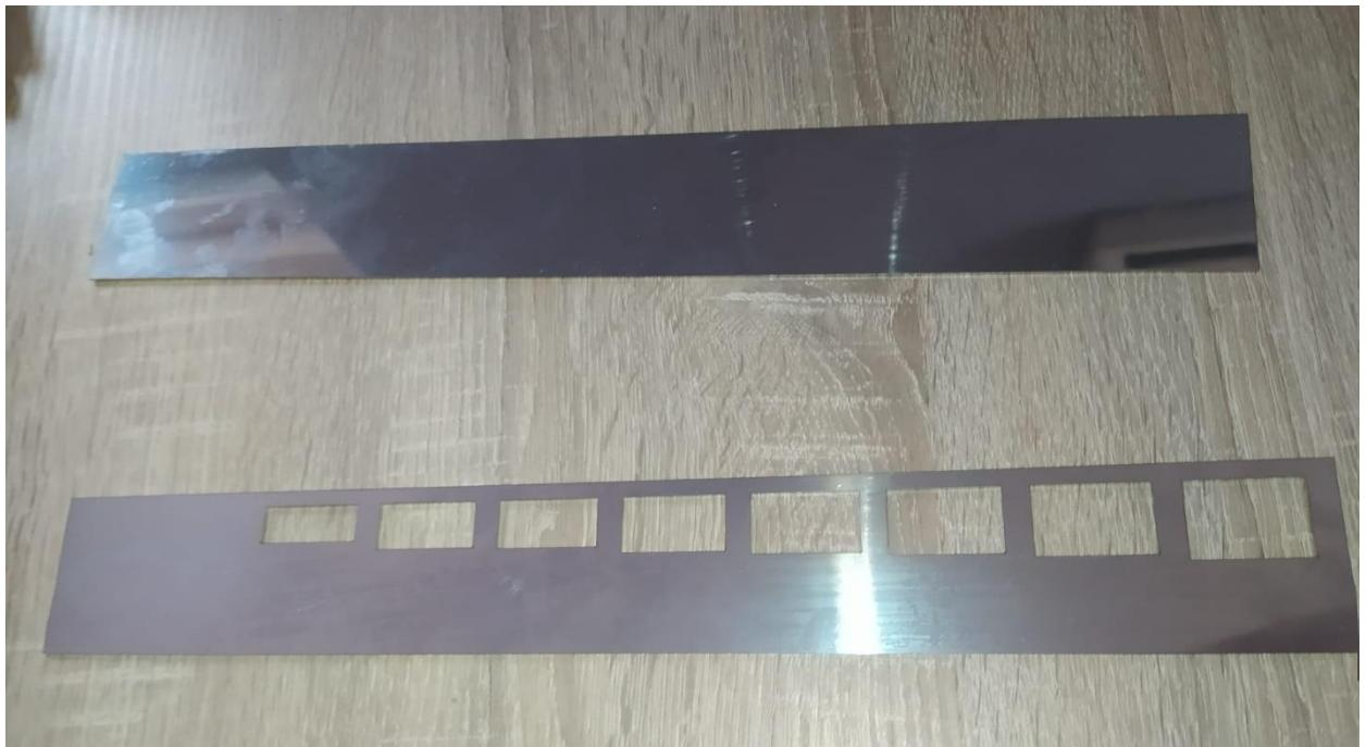
**Slika 3.5.** Metalne pločice izrezane CNC strojem.
