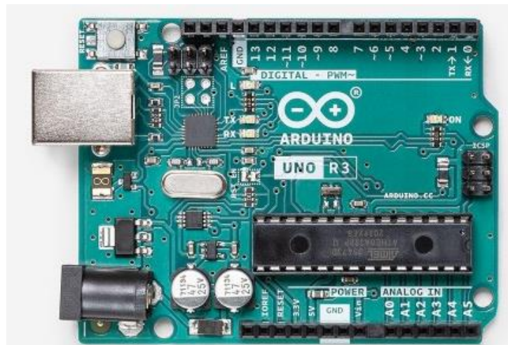
Slika 2.6. Primjer mikroupravljačke pločice[8]
