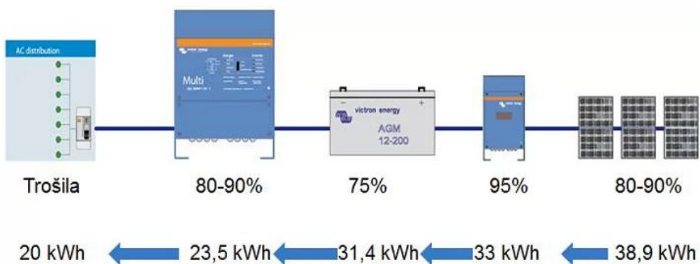
Slika 29. Utjecaj efikasnosti punjenja olovne baterije u fotonaponskom sustavu [9]
