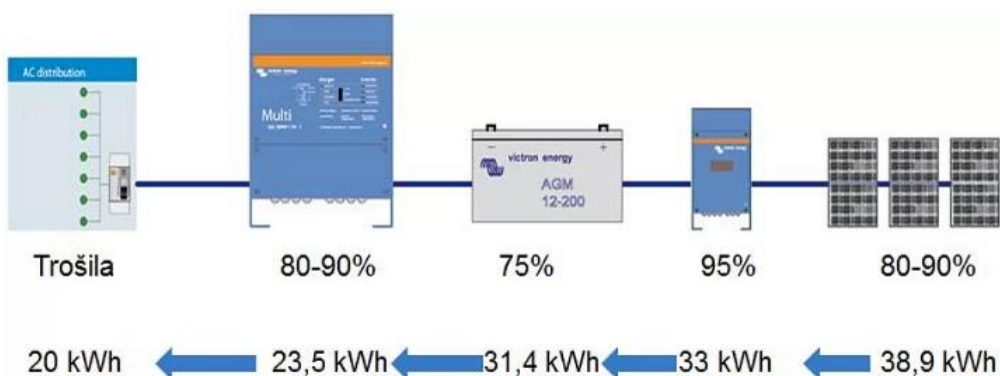
Slika 29. Utjecaj efikasnosti punjenja olovne baterije u fotonaponskom sustavu [9]
