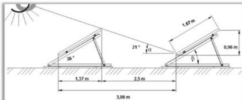
Slika 12. Konstrukcija za fotonaponske panele na ravnom krovu. [7]
