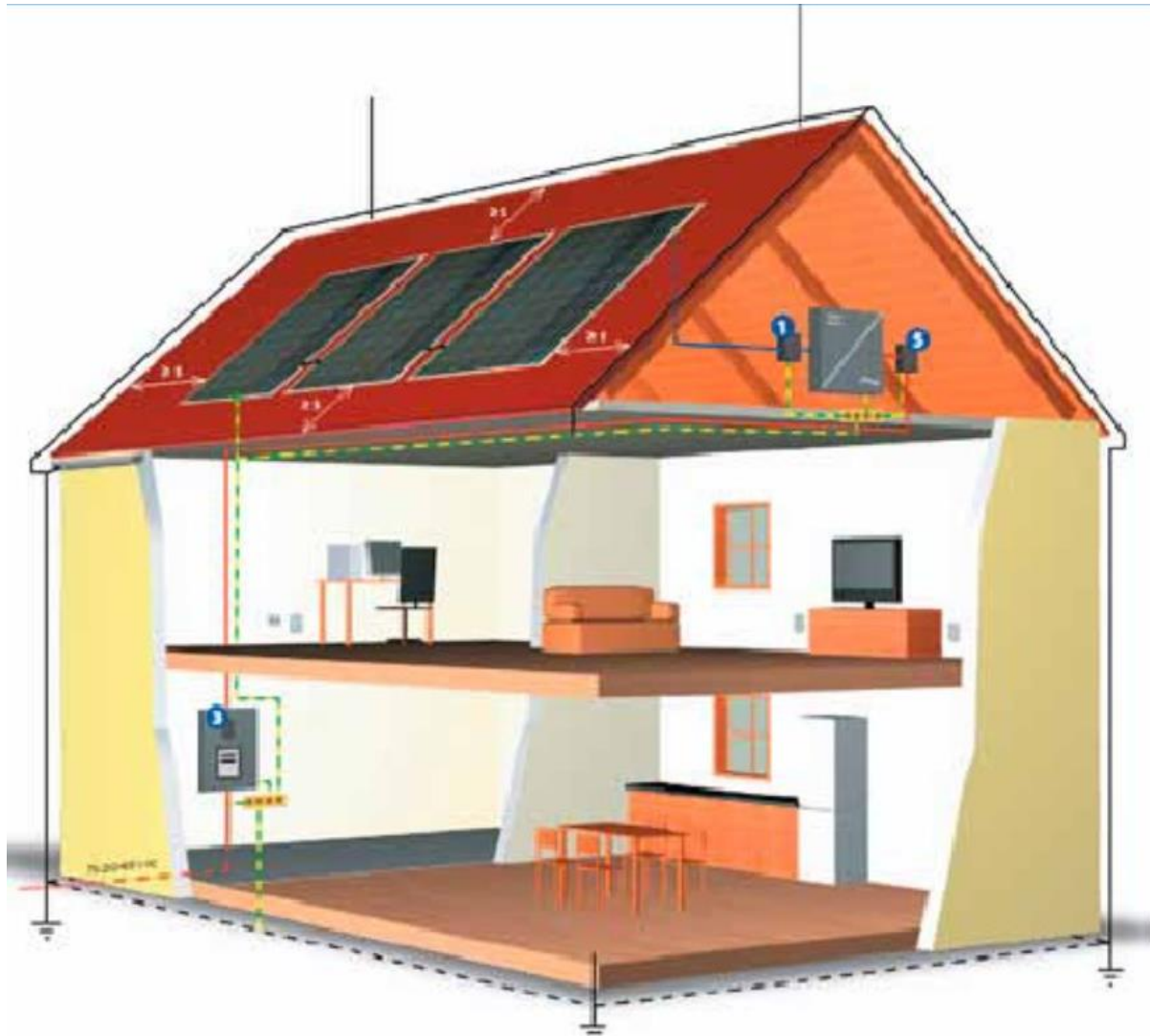
Slika 40. Fotonaponski sustav i gromobranska instalacija objekta [2]
