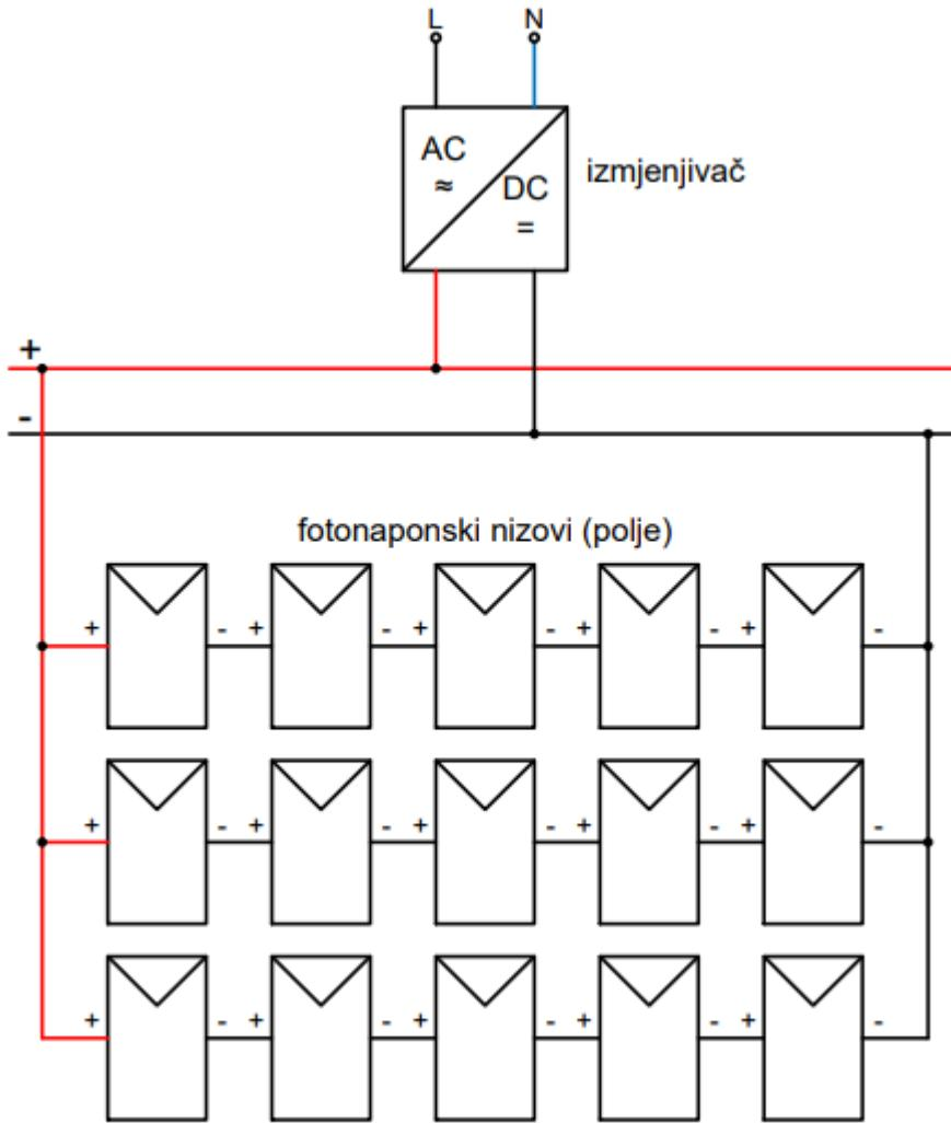
Slika 34. Izvedba fotonaponskih elektrana s jednim inverterom. [1]
