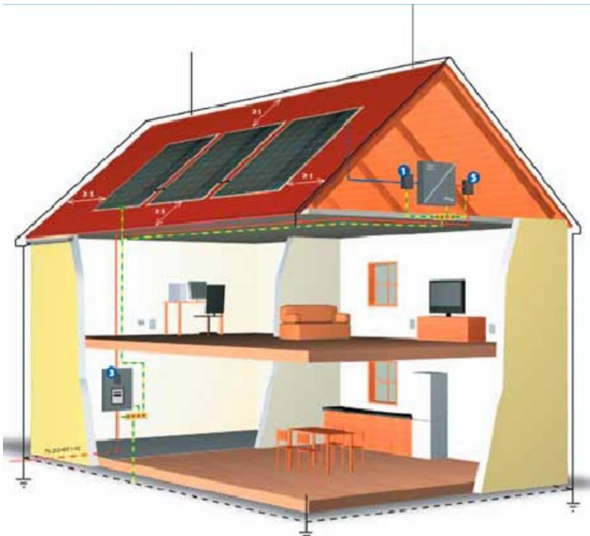
Slika 40. Fotonaponski sustav i gromobranska instalacija objekta [2]
