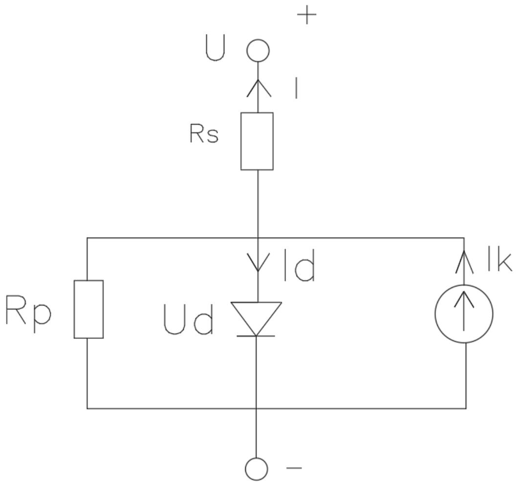
Slika 3. Nadomjesna shema fotonaponske ćelije
