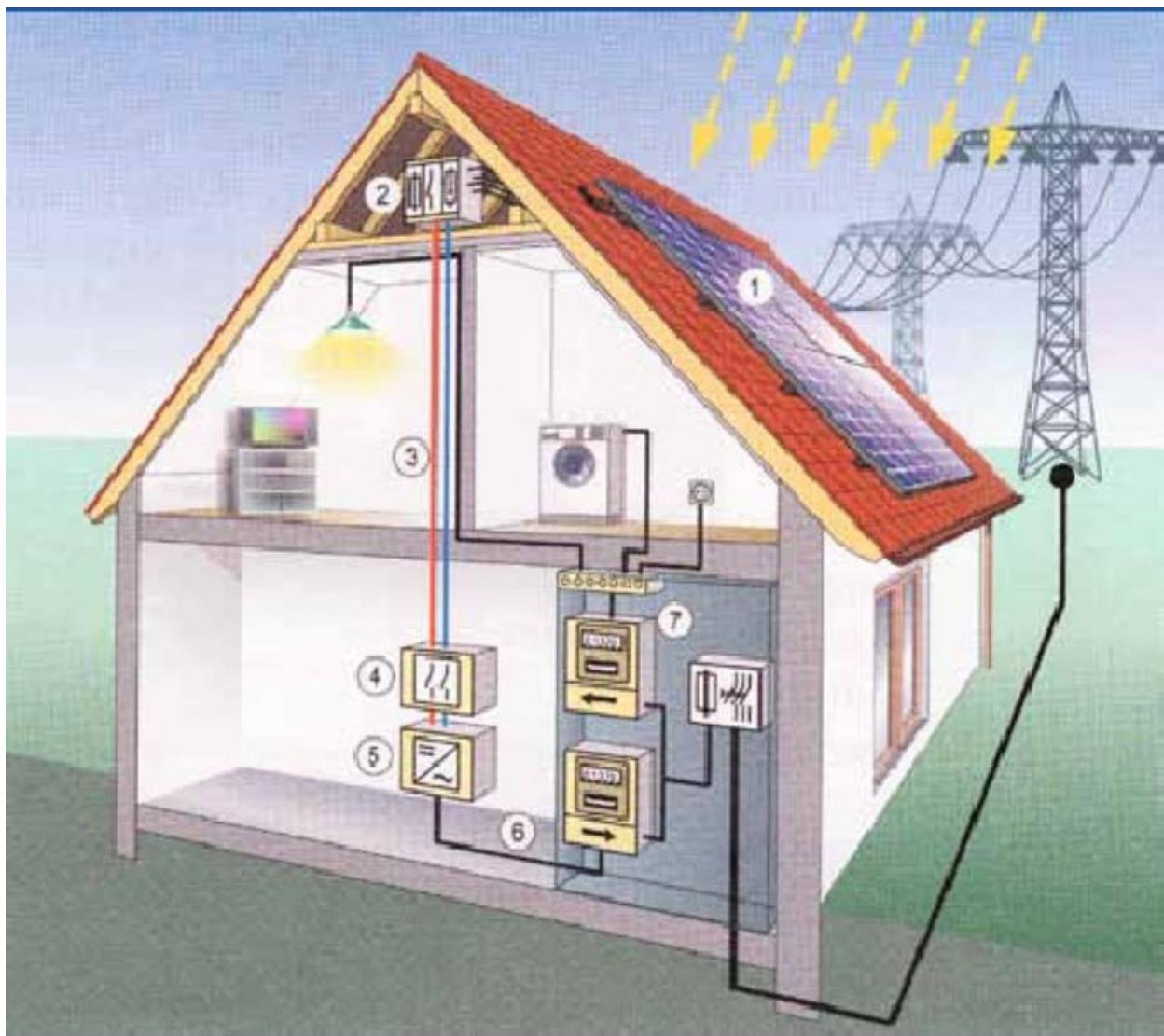
Slika 33. Mrežna fotonaponska elektrana spojena preko kućne instalacije [2]
