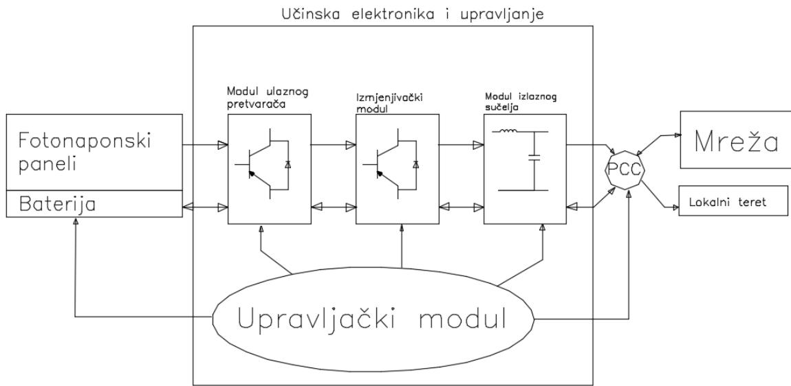
Slika 16. Shematski prikaz ispravljajućkog i upravljućkog kruga FN sustava
