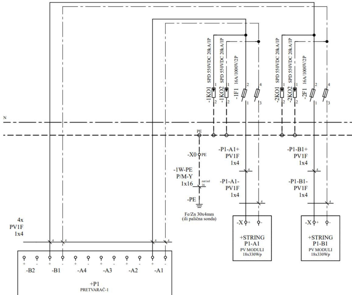
Slika 21. Shema istosmjernog razvodnog ormara za fotonaponsku elektranu izlazne snage 12 kW
