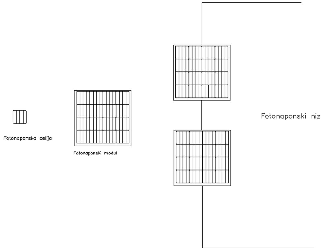
Slika 6. Prikaz fotonaponske čelije, modula i niza
