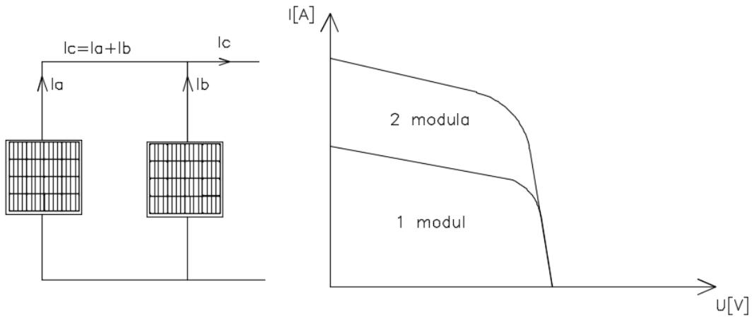
Slika 9. Paralelni spoj dva fotonaponska modula i njihova I-U karakteristika
