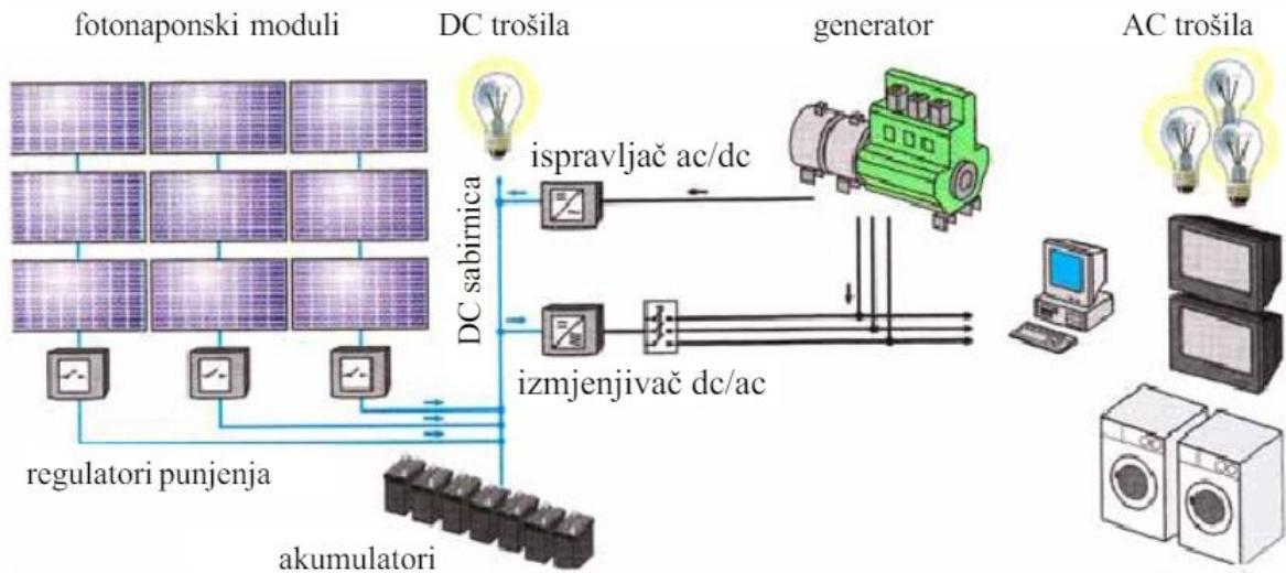
Slika 39. Shema autonomnog hibridnog sustava s generatorom [2]
