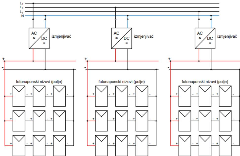
Slika 36. Solarne elektrana s više inverteera [1]
