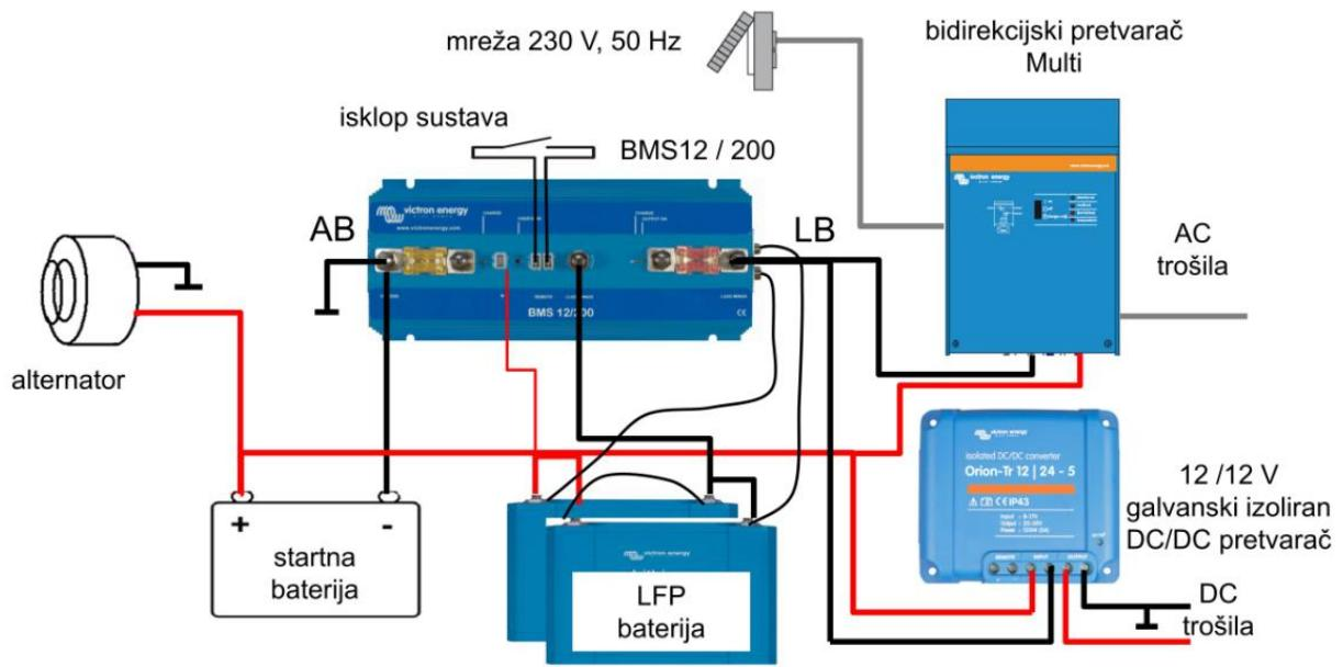
Slika 31. Primjer sustava nadzora stanja baterije [9]
