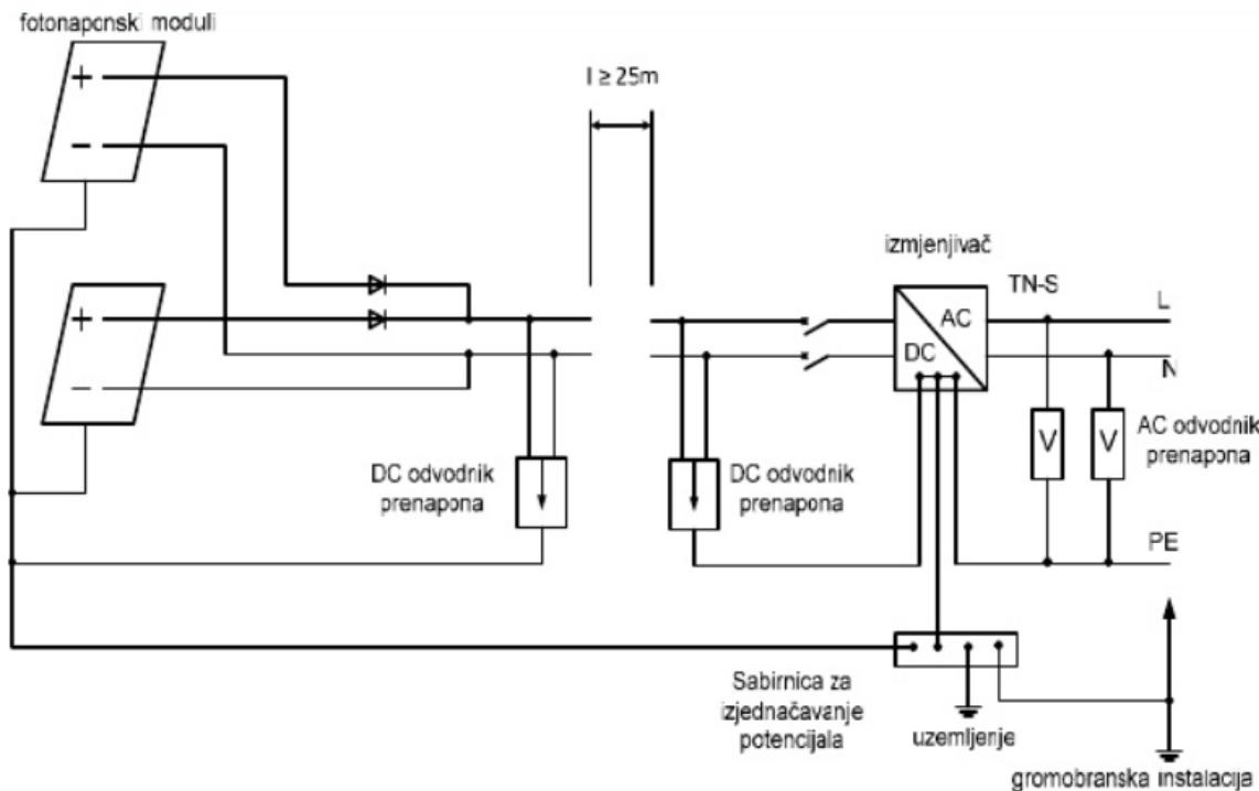
Slika 41. Zaštita fotonaponskog sustava uzemljenjem i odvodnicima prenapona [2]
