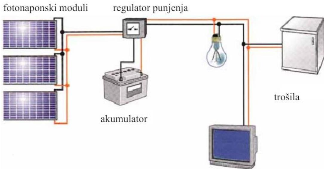
Slika 38. Autonomni fotonaponski sustav s baterijom [2]
