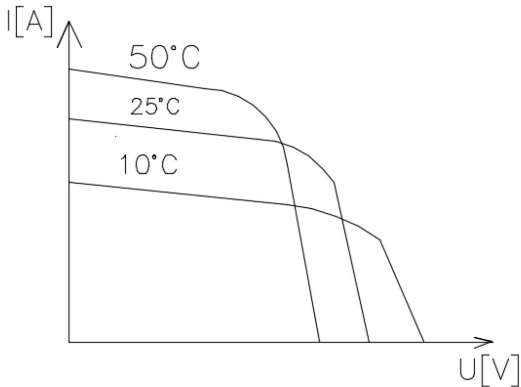
Slika 5. Prikazuje promjenu I-U karakteristike ovisno o temperature čelije
