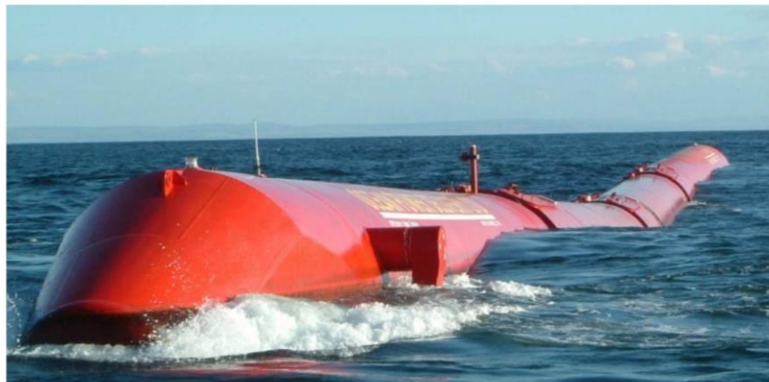
Slika 2.1 Pelamis P1 – primjer prigušnika. Reproducirano uz dopuštenje od [7]
