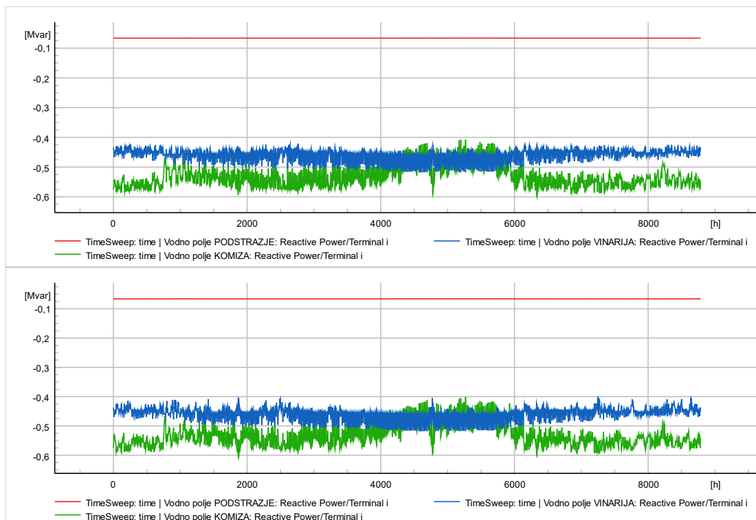
Slika 3.29 Radno opterećenje na glavnim dalekovodnim linijama nakon integriranja WPF-a i BESS-a na lokaciji 1
