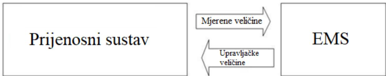
**Slika 3.1.** Shema upravljanja elektroenergetskog sustava pomoću EMS-a [7]
