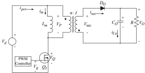
*Slika 2.1.* Shematski prikaz povratnog (flyback) pretvarača [4]
