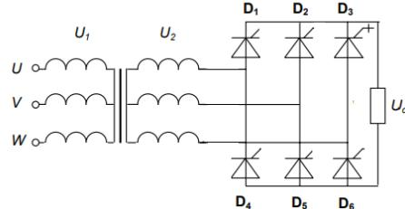
*Slika 3.9.* SCR mosna izvedba trofaznog punovalnog ispravljača [10]
