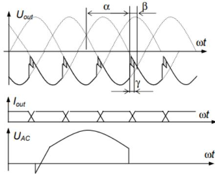
**Slika 3.12.** Dijagrami napona i struje trofaznog pretvarača [10]
