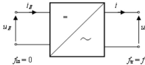
**3.10.** Simbol jednofaznog izmjenjivača i referentni smjerovi napona na priključcima [9]
