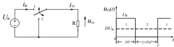
*Slika 3.16.* Strujni krug i naponske karakteristike silaznog pretvarača [11]
