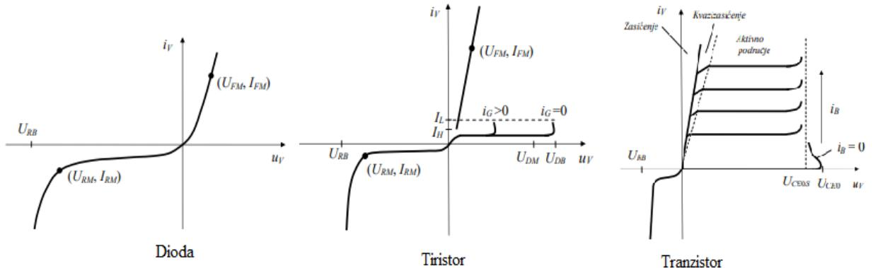
**Slika 3.2.** Tipične  $U$ - $I$  karakteristike primarnih poluvodičkih komponenti
