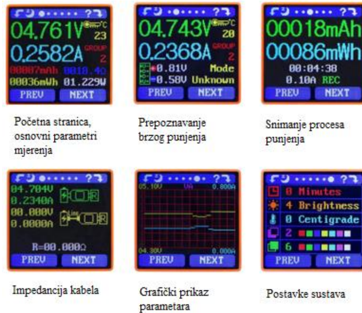
Slika 4.4. Prikaz trenutnih parametara pomoću zaslona UM25C [14]
