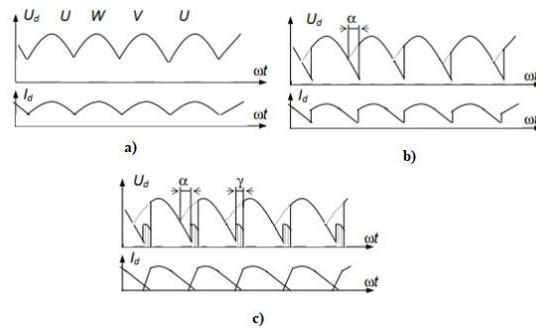
**Slika 3.8.** Strujne i naponske karakteristike trofaznog punovaljnog ispravljača [10]
