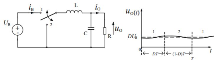
*Slika 3.17.* Strujni krug i naponske karakteristike pretvarača s niskonaponskim filtrom [11]
