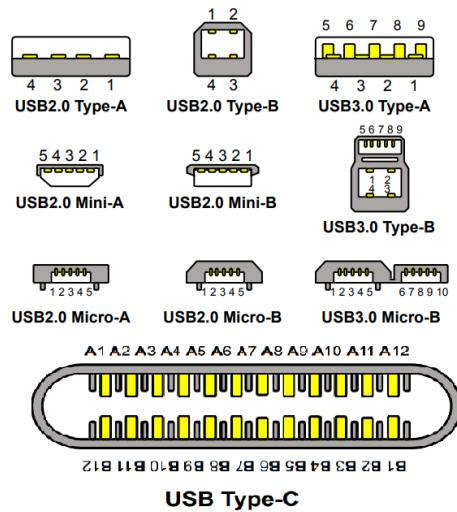
*Slika 2.2. Prikaz USB konektora sa označenim brojem pinova [5]*
