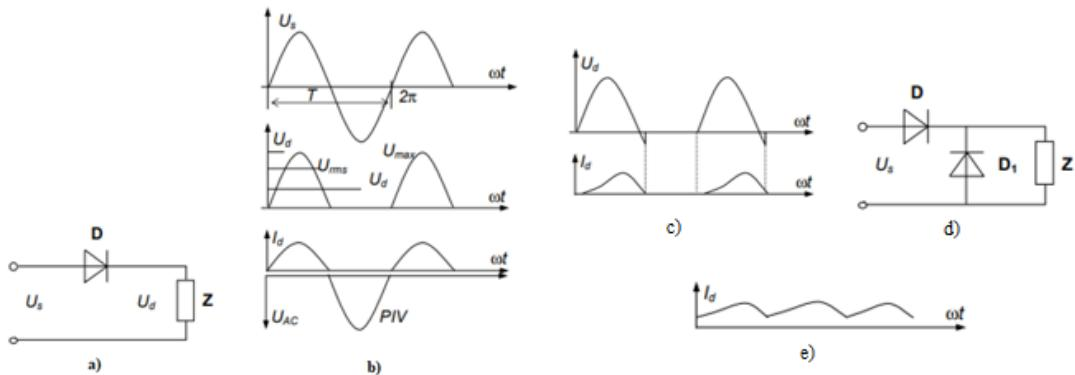
*Slika 3.4.* Diodni ispravljači sa aktivnim i induktivnim opterećenjem [10]
