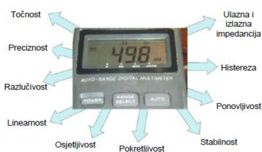
Slika 3.1 Prikaz karakteristika mjernog instrumenta [2]
