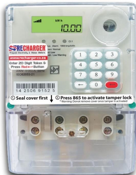
Slika 2.4. Obračunsko brojilo s mogućnošću unosa prepaid bonova [6]
