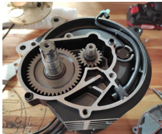
Sl. 6.4 Prikaz mjenjača brzine motora QS138 70H V3
