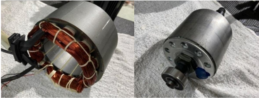
Sl. 6.3 Stator i rotor motora QS138 70H
