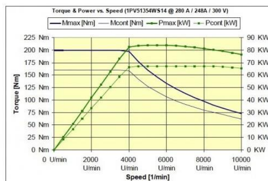
Sl. 3.2 Specifikacije motora Siemens 1PV5135-4WS14 [6]
