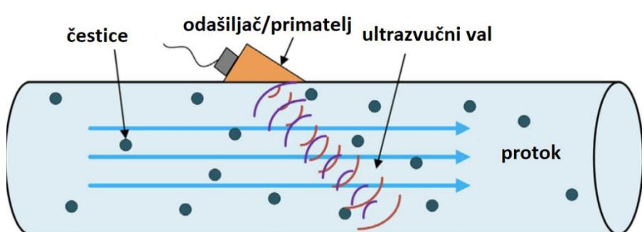
Slika 4.30 Načelo rada Doppler ultrazvučnog mjerila protoka[30]
