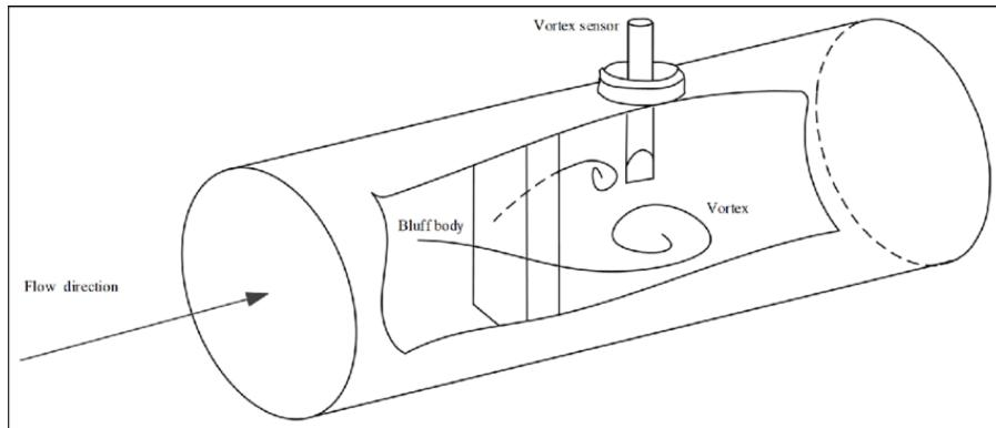
Slika 4.18 načelo rada vrtložnog mjerila protoka [18]
