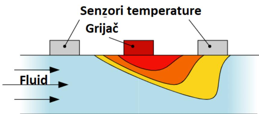
Slika 4.15 termodinamičko mjerilo na principu mjerena promjene temperature[15]
