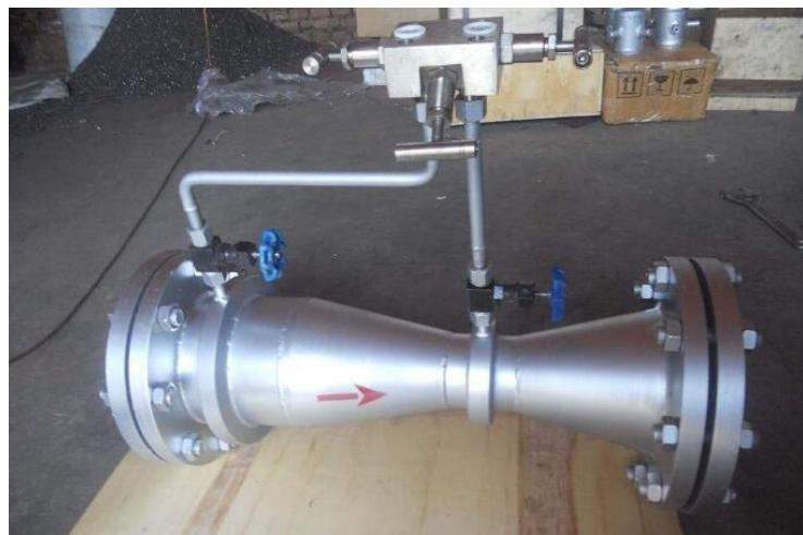
Slika 4.5 venturijeva cijev u praksi[5]
