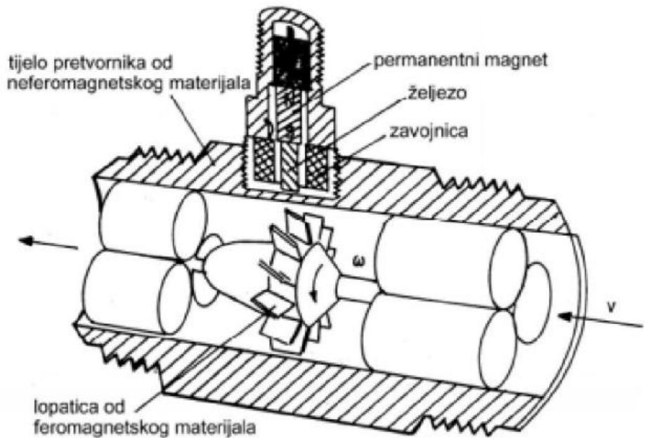
**Slika 4.22** Načelo rada turbinskog mjerila protoka [22]
