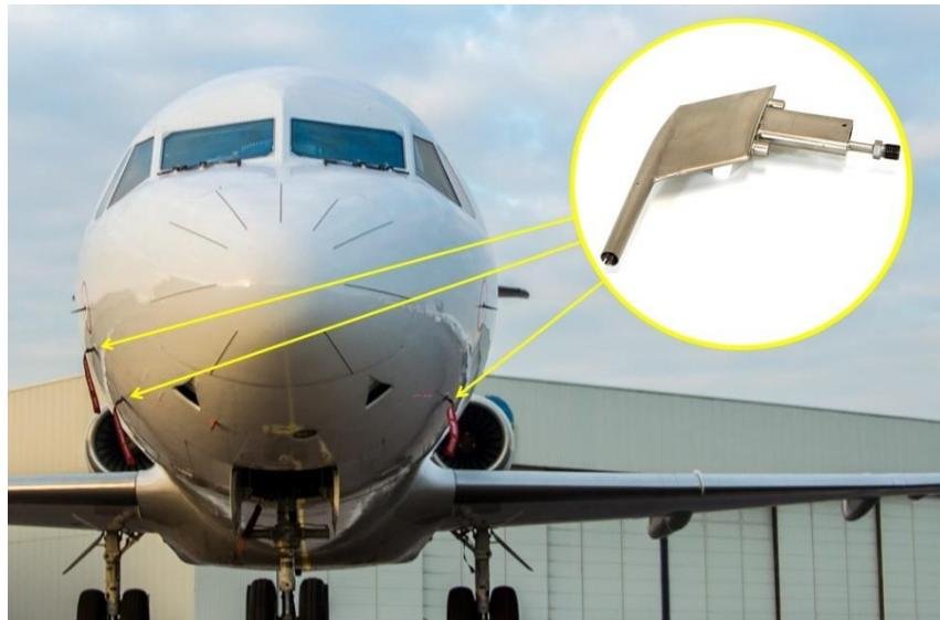
**Slika 4.9** primjena pitotove cijevi u zrakoplovstvu za mjerjenje strujanje zraka[9]
