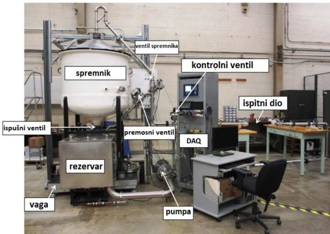
Slika 4.17 Maseni mjerači protoka temeljeni na gravimetriji [17]
