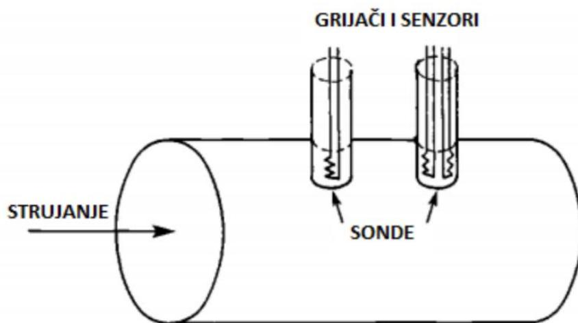
Slika 4.13 termodinamičko mjerilo na principu mjerena potrošnje energije
