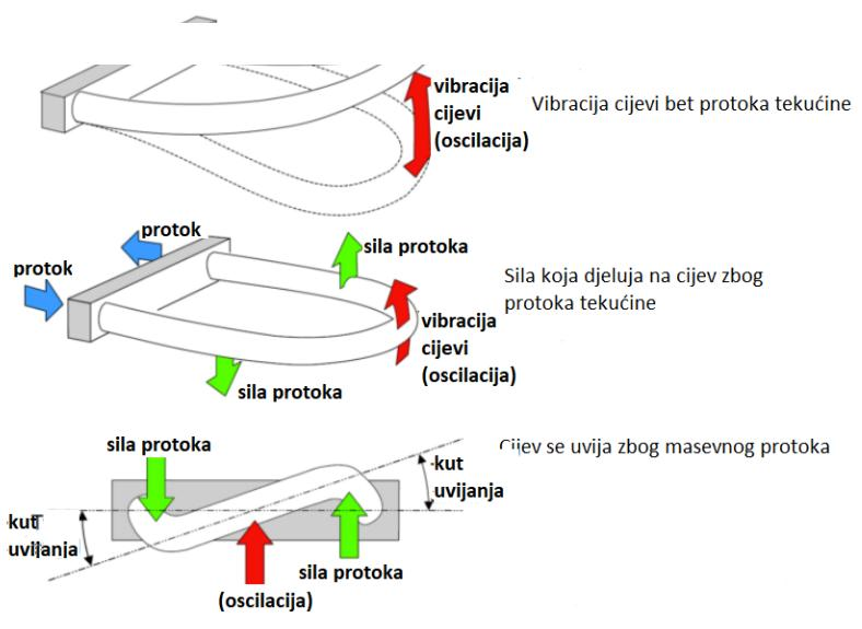
Slika 4.12 načelo radara Coriolisov protokomjera[12]
