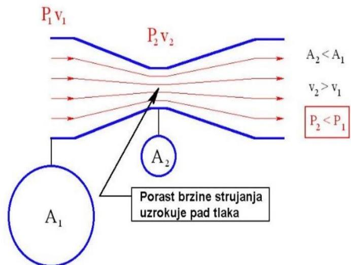
**Slika 4.1** suženje u cijevi uzrokuje pad tlaka i povećanje brzine strujanja
