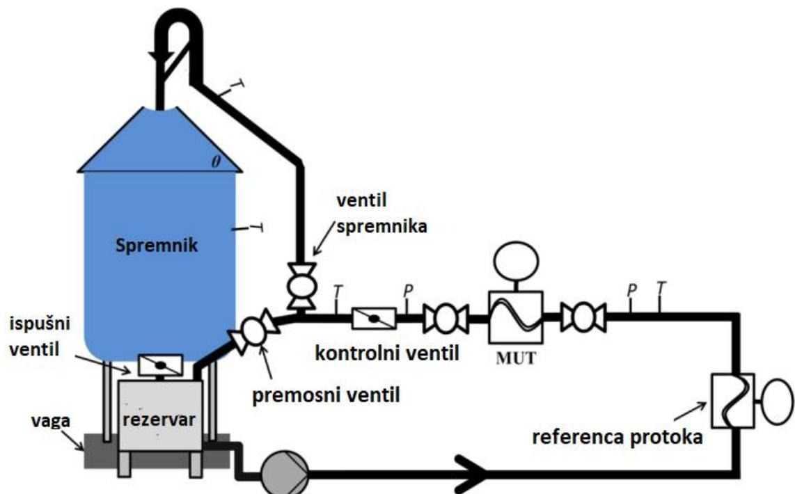
Slika 4.16 Načelo rada masenog mjerila protoka temeljeni na gravimetriji [16]
