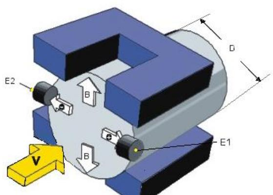
Slika 4.27 Načelo rada elektromagnetskog mjerila [27]
