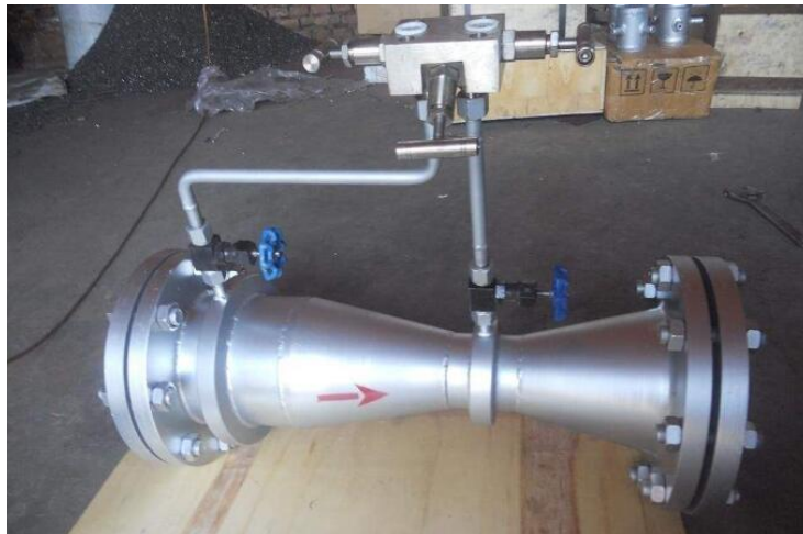
Slika 4.5 venturijeva cijev u praksi[5]
