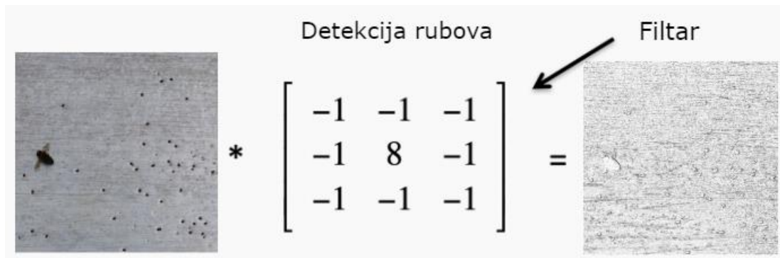
Slika 3.8 Primjer korištenja filtera unutar konvolucijskog sloja
