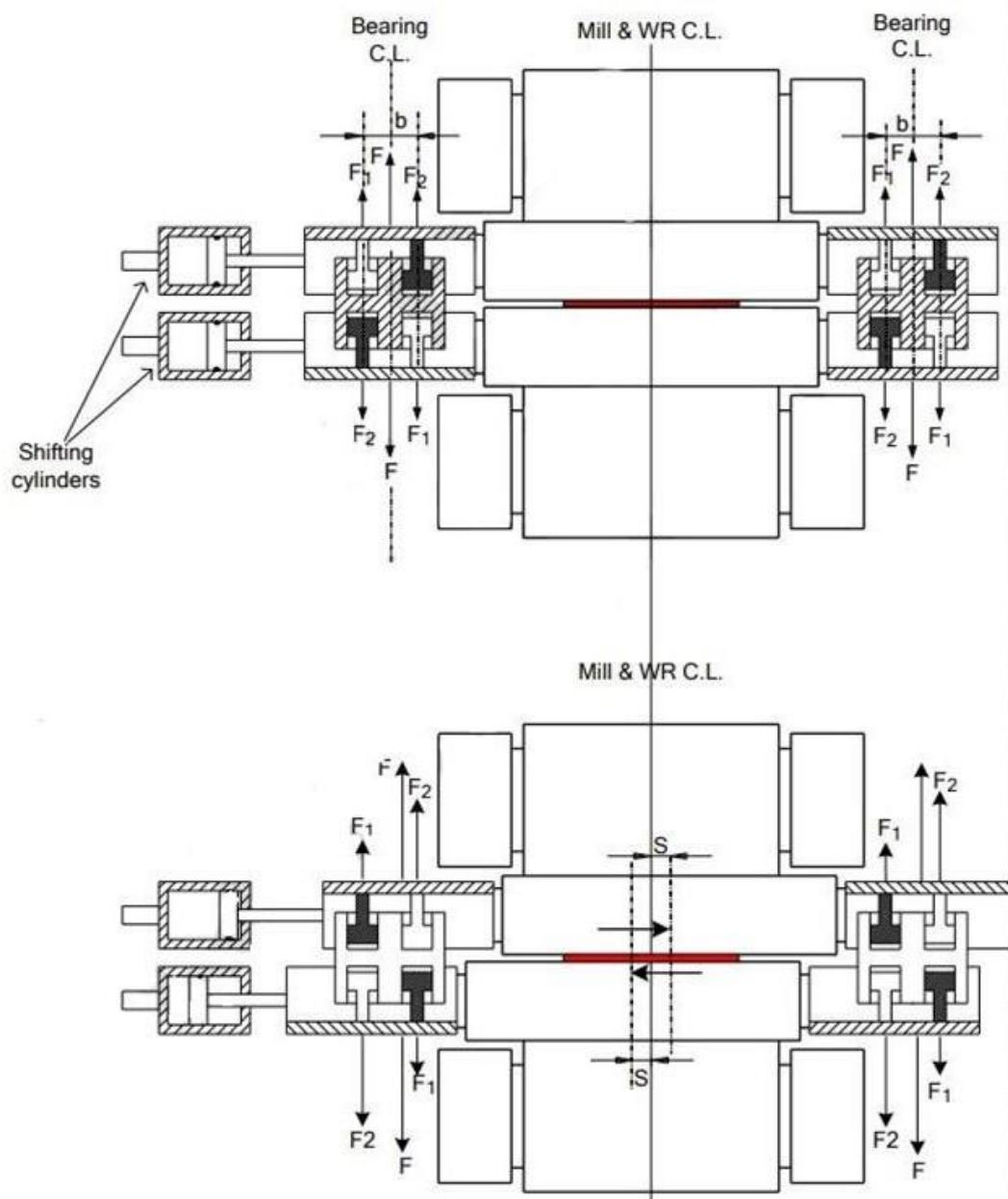
**Sl. 2.10.** Smjerovi davanja sila za savijanje i bočno pomicanje [1]
