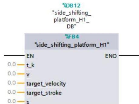
Sl. 3.8. Funkcijski blok uređaja pomicne platforme
