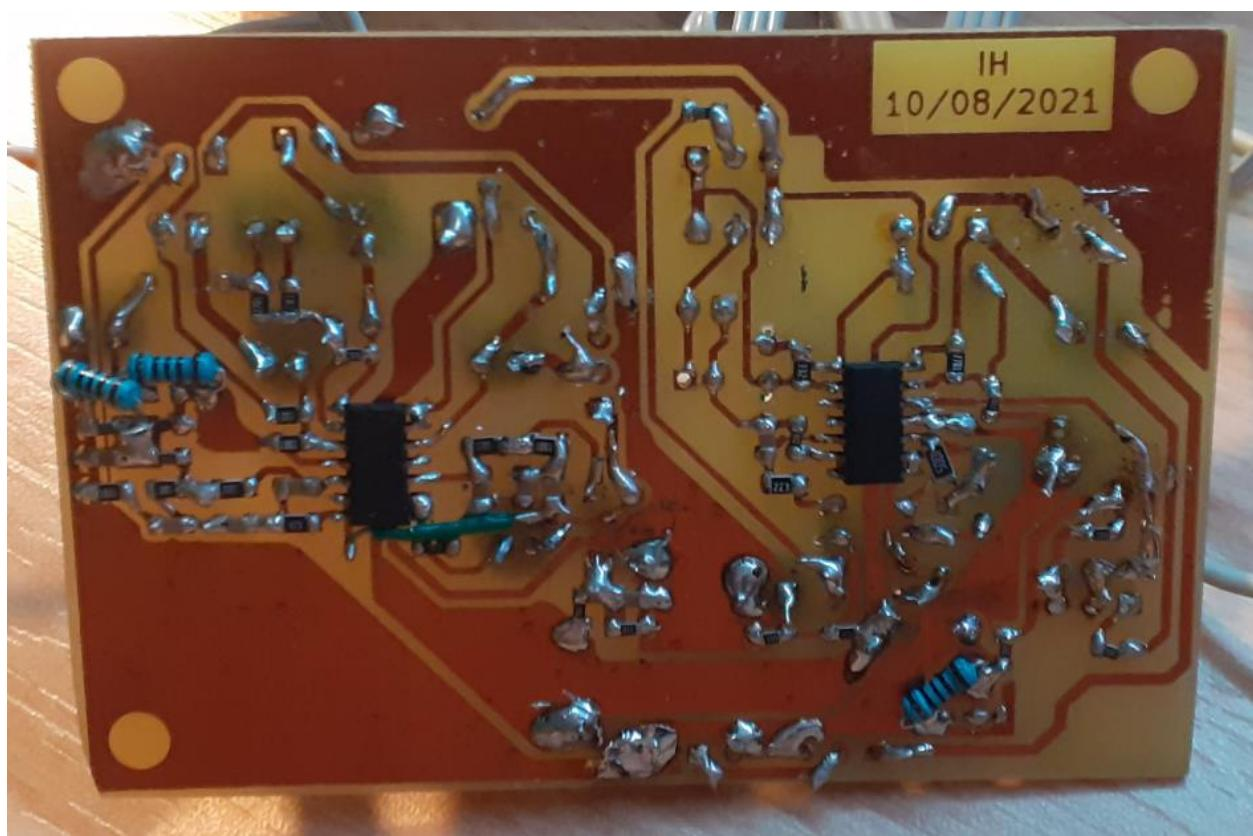
Slika 6.2. Zadnja strana tiskane pločice predpojačala
