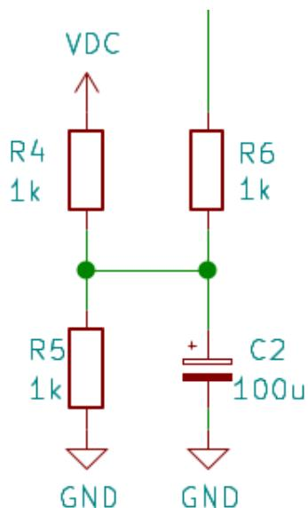
Slika 3.11. Sklop za postavljanje radne točke
