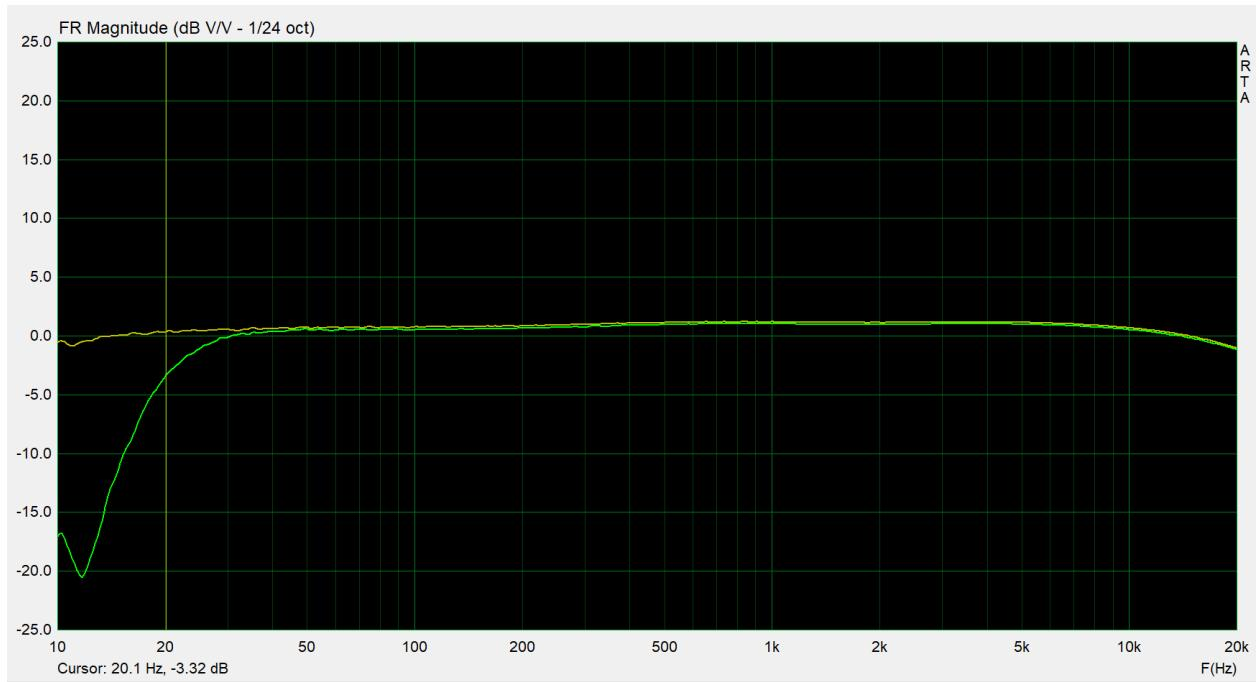
Slika 3.14. Frekvencijska karakteristika sa i bez filtera
