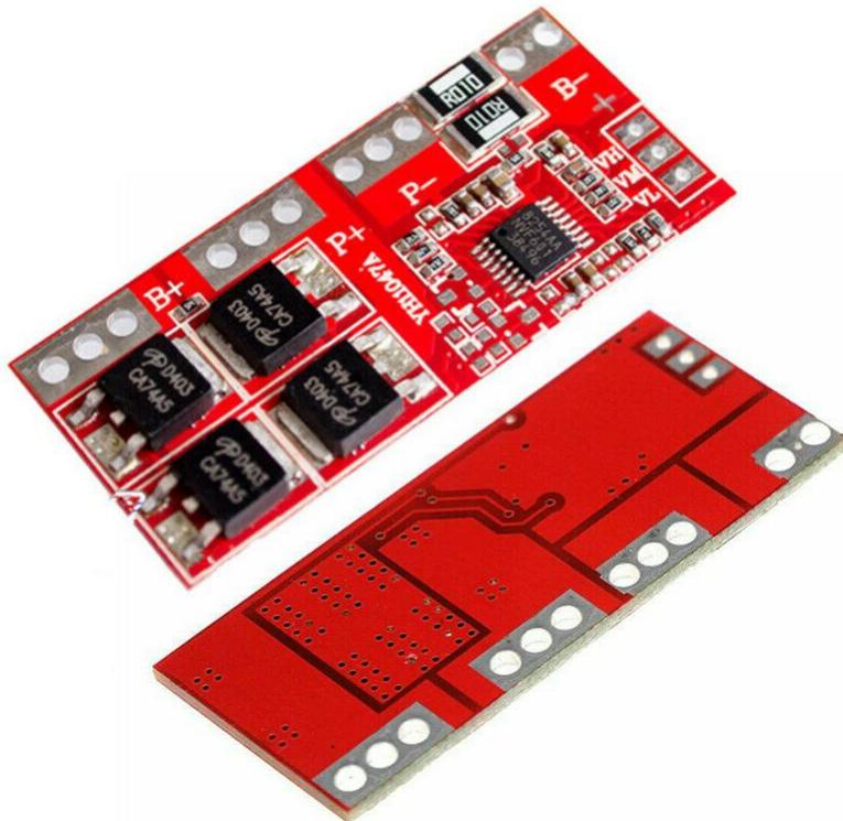
Slika 5.1. Gotova izvedba sustava za upravljanje baterijama
