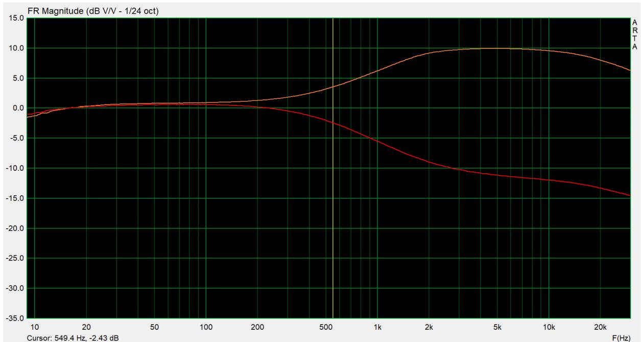
Slika 3.15. frekvencijska karakteristika pri mijenjanju treble kontrole na max i min položaj
