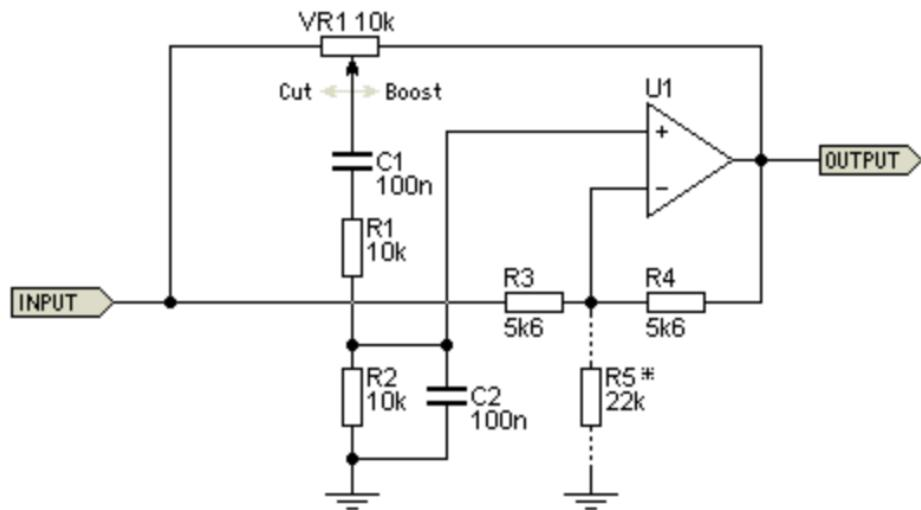
Slika 3.8. Wien-ov most u shemi s operacijskim pojačalom
