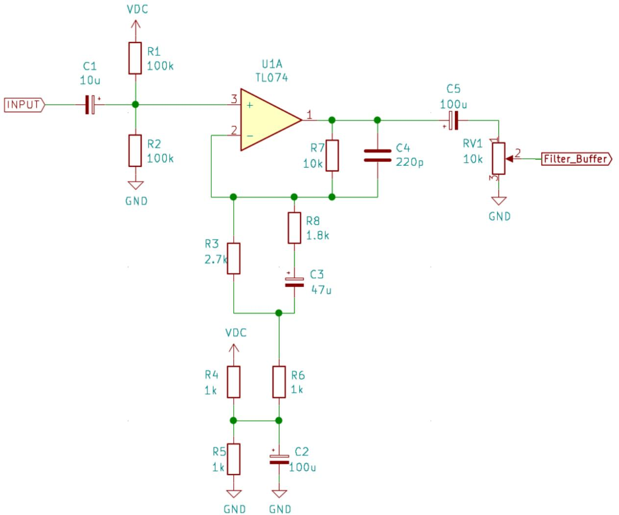
Slika 3.1. Shema ulaznog stupnja predpojačala
