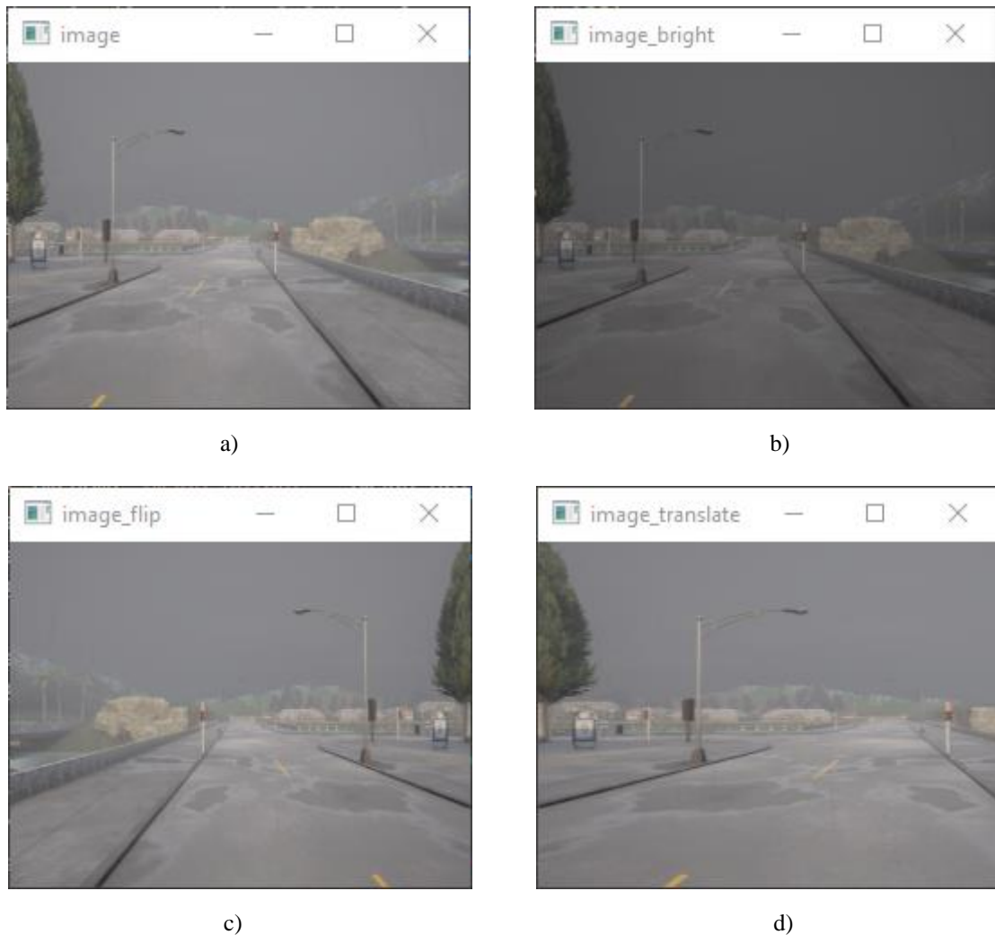
Slika 3.10. a) Izvorna slika sa oznakom 0.0, b) slika kojoj je promijenjena svjetlina, c) okrenuta slika, d) slika sa promijenjenim kutom gledišta te sa novom oznakom 0.146.
