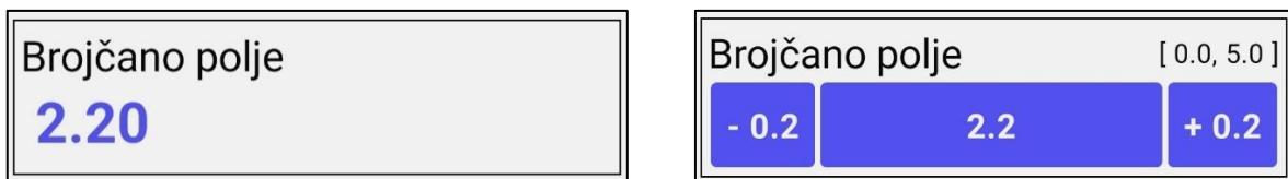
Slika 3.53 a) Izgled brojčanog polja u jednosmjernom i b) dvosmjernom načinu rada
