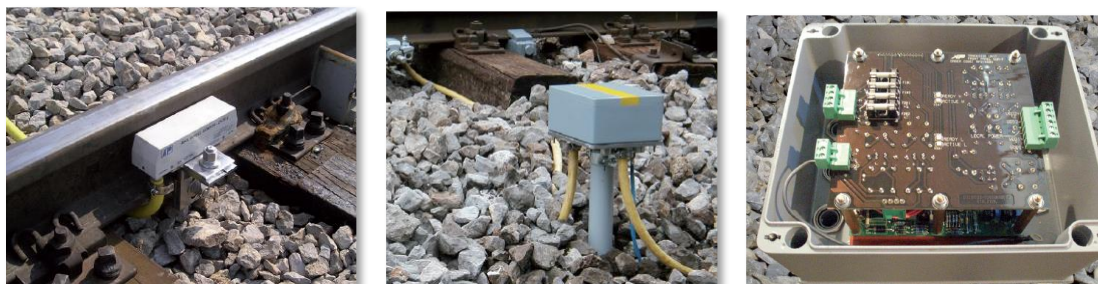
Slika 3.5. – a. Induktivni senzor kotača b. Montirana kutija elektroničkog kontrolnog sklopa c. Komponente elektroničkog kontrolnog sklopa [12]
