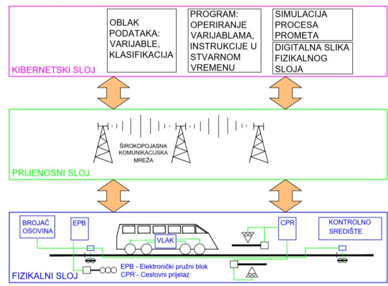
Slika 3.1. – Slojevi kibernetosko-fizikalnog modela signalno-sigurnosnog sustava željeznice
