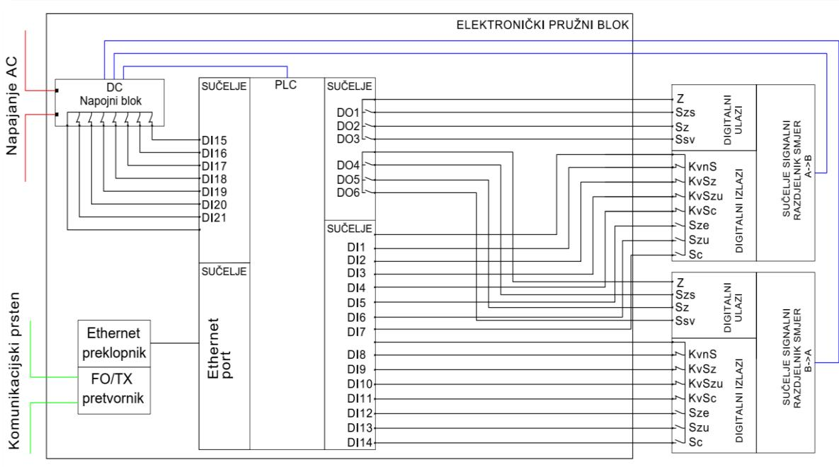
Slika 3.4. – Shema elektroničkog pružnog bloka s ugrađenim računalom
