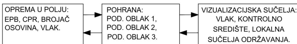
Slika 5.1. – Razmjena podataka u kibernetko-fizikalnom modelu signalno-sigurnosnog sustava željeznice
