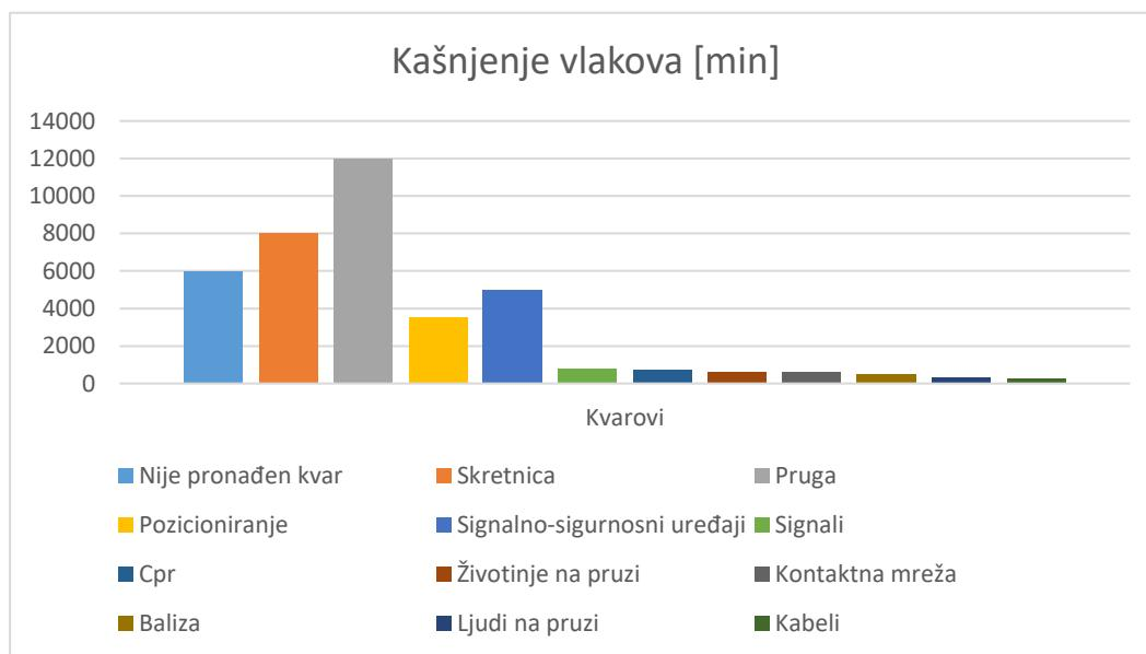
Slika 6.12. – Kašnjenje vlakova u ovisnosti od vrste kvara
