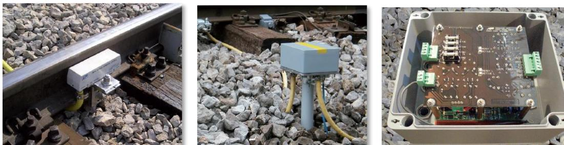
Slika 3.5. – a. Induktivni senzor kotača b. Montirana kutija električkog kontrolnog sklopa c. Komponente električkog kontrolnog sklopa [12]
