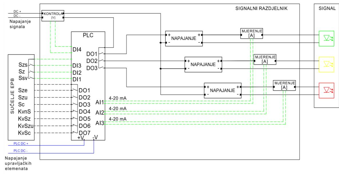
Slika 3.3. – Shema signalnog razdjelnika s ugrađenim računalom
