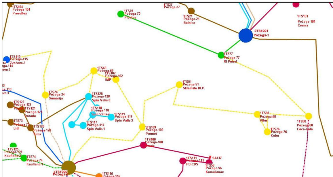
Slika 7-2 Optimirano stanje napajanja 10 kV DV Plodine – DV Promet
