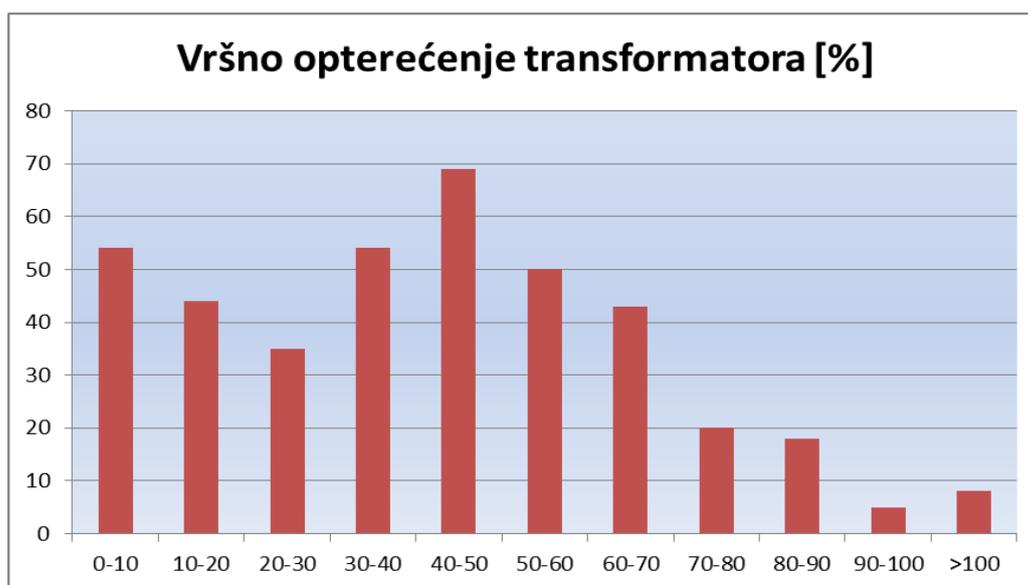
Slika 6-3 Relativno vršno opterećenje transformatora u 2017. godini
