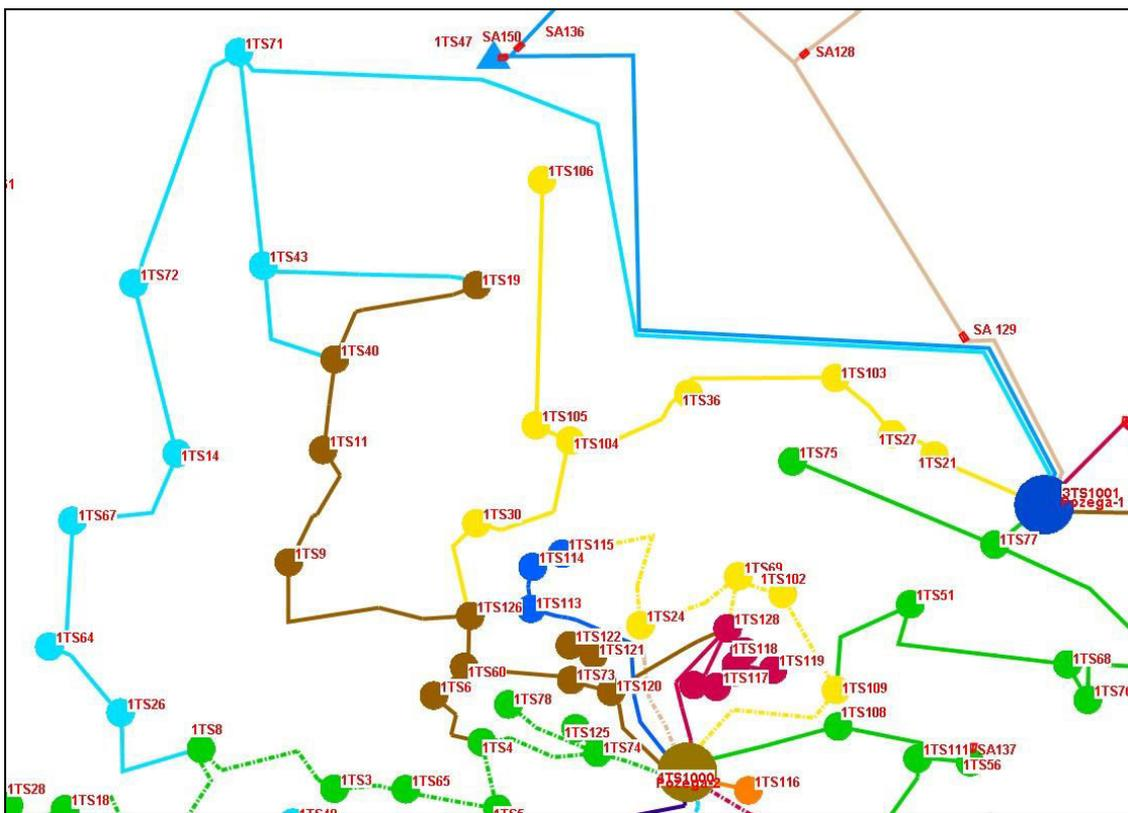
Slika 7-4 Optimirano stanje napajanja 10 kV DV Veličanka – DV Silos
