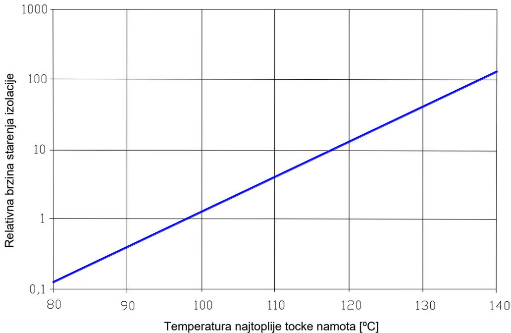
**Slika 2-2 Funkcija ovisnosti relativne brzine starenja izolacije za papir u ulju (toplinska klasa A) o temperaturi najtoplije točke namota**
