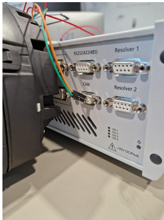
Slika 4.5. CAN_H i CAN_L spojevi na RS232 konektoru MicroLabBoxa
