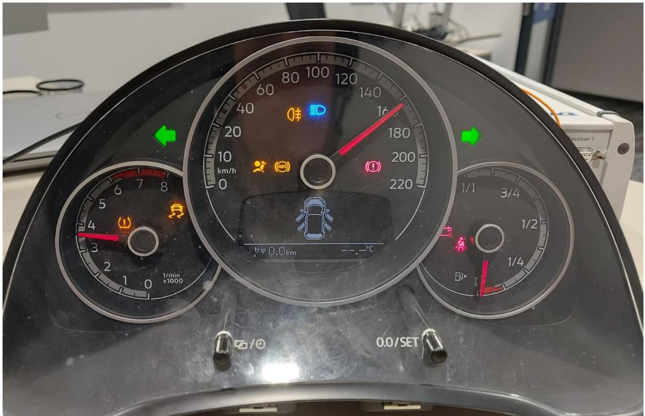
Slika 5.22. Prikaz svih mogućih akcija na kontrolnoj ploči
