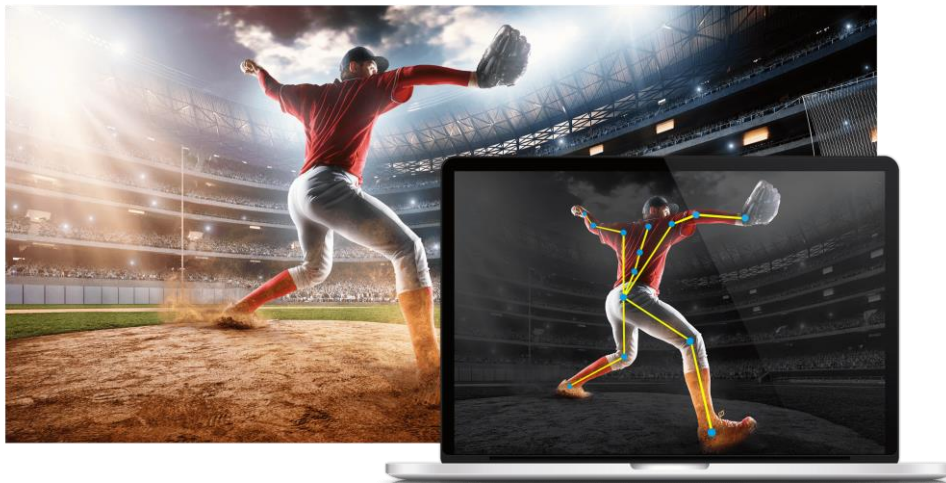
Slika 2.4. Sustav snimanje pokreta bez markera[13].
