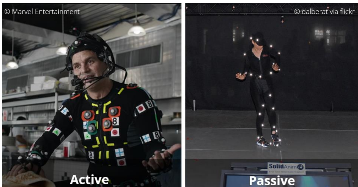
Slika 2.3. Aktivni i pasivni optički sustavi snimanja pokreta[11].
