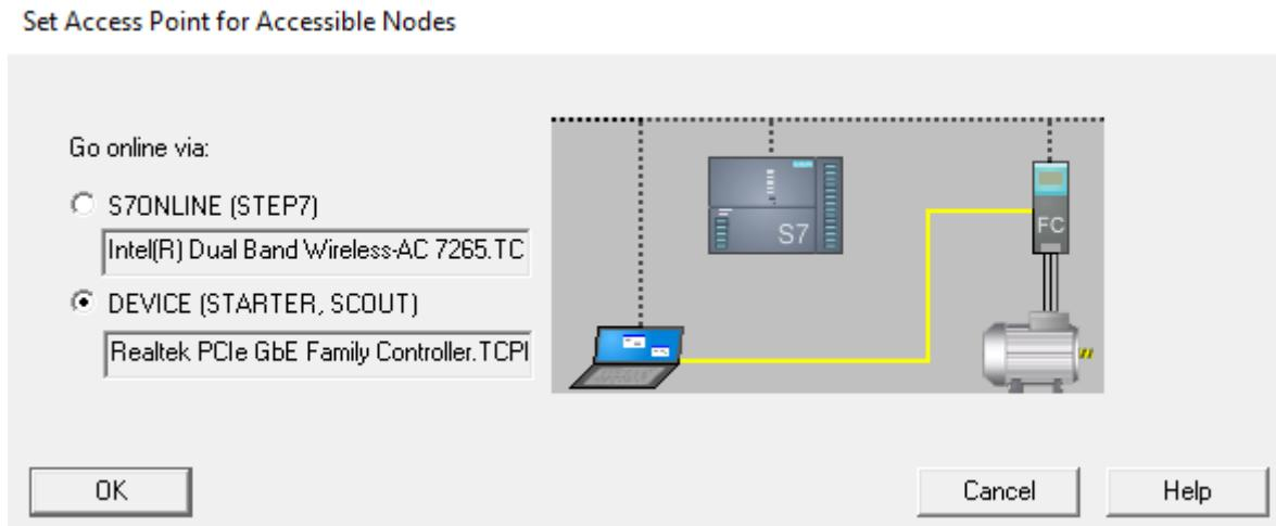
Slika 4.11 a) Direktno povezivanje računala sa frekvencijskim pretvaračem
