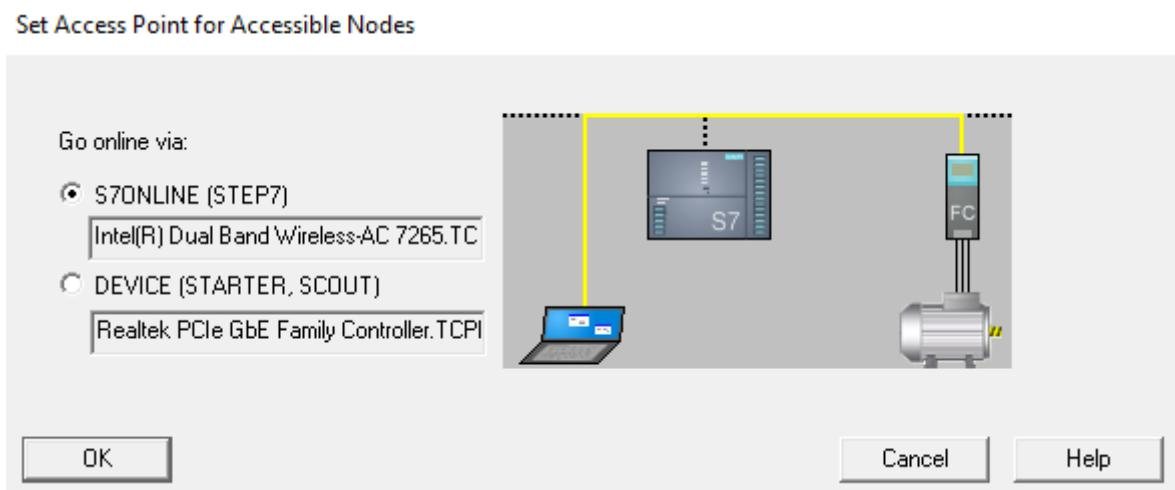
Slika 4.11. b) Povezivanje računala preko STEP7 sučelja sa frekvencijskim pretvaračem
