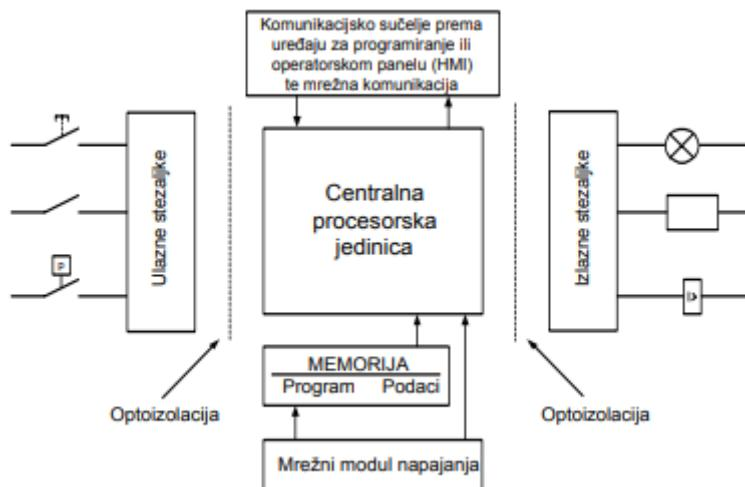
Slika 4.18 Dijelovi PLC-a [9]
