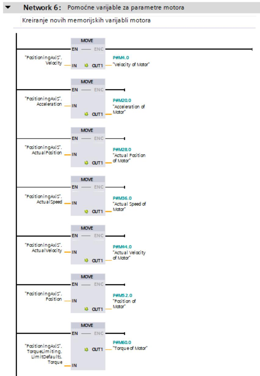
Slika 5.17 Spremanje parametara motora u nove varijable
