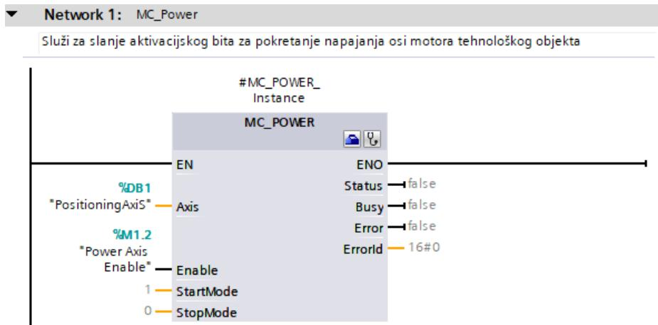
Slika 5.10 Poziv tehnološkog objekta "MC\_Power"
