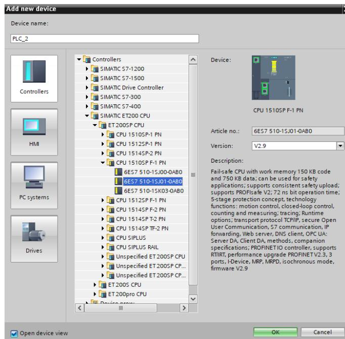
Slika 4.21 Odabir procesorske jedinice PLC-a
