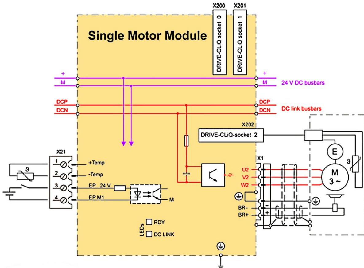
Slika 4.4 Blok dijagram povezivanja motornog modula [7]
