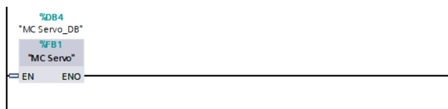
Slika 5.9 Poziv "MC\_Servo" data bloka unutar "Main" funkcije
