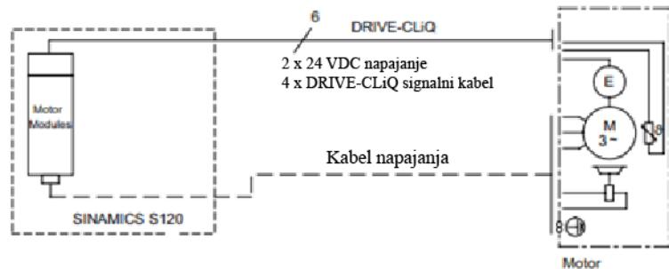
Slika 4.6 Shematski prikaz spoja motora sa frekvencijskim pretvaračem [8]
