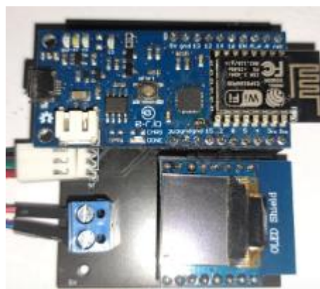
Sl. 3.7 PCB sa zalemljenim komponentama
