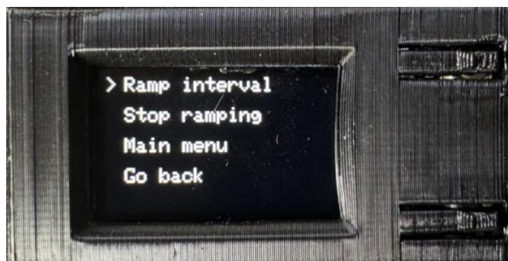
Slika 5.8. Izbornik za kontrolu izvođenja time-lap-se-a
