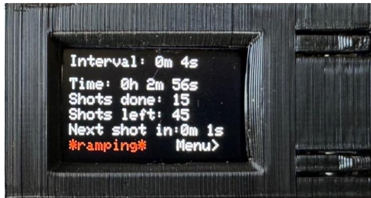
Slika 5.11. Izvođenje time-lapse -a uz ramping intervala
