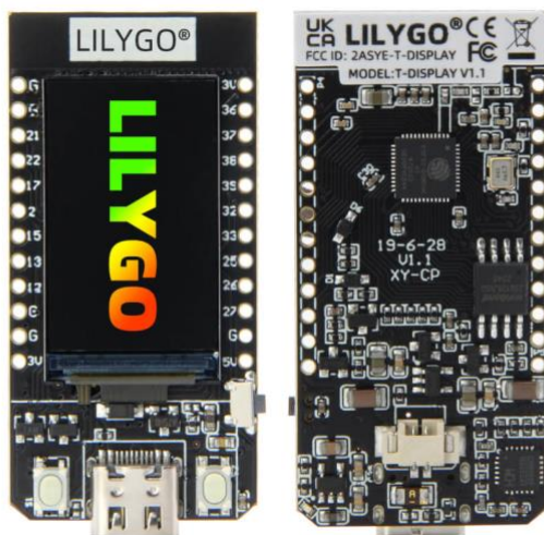
Slika 4.2. LilyGo TTGO Display razvojna ploča
