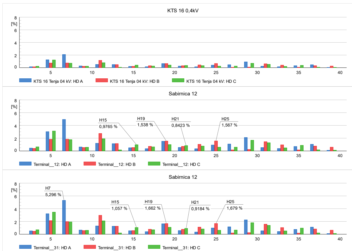
Slika 5.26. Stanje ispitne mreže u 14:00 h na karakterističnim sabirnicama prije optimizacije
