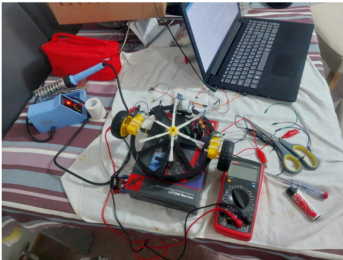
Slika 3.6. Sklapanje komponenata i lijepljenje kućišta.
