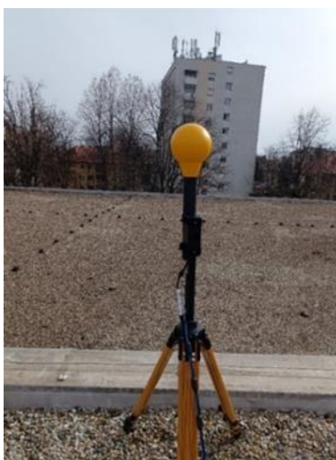
Slika 5.1. NARDA SRM-3006 mjerni sustav
