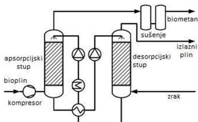
**Sl. 2.6.** Shema procesa za pročišćavanje bioplina pomoću pranja vodom pod pritiskom,
