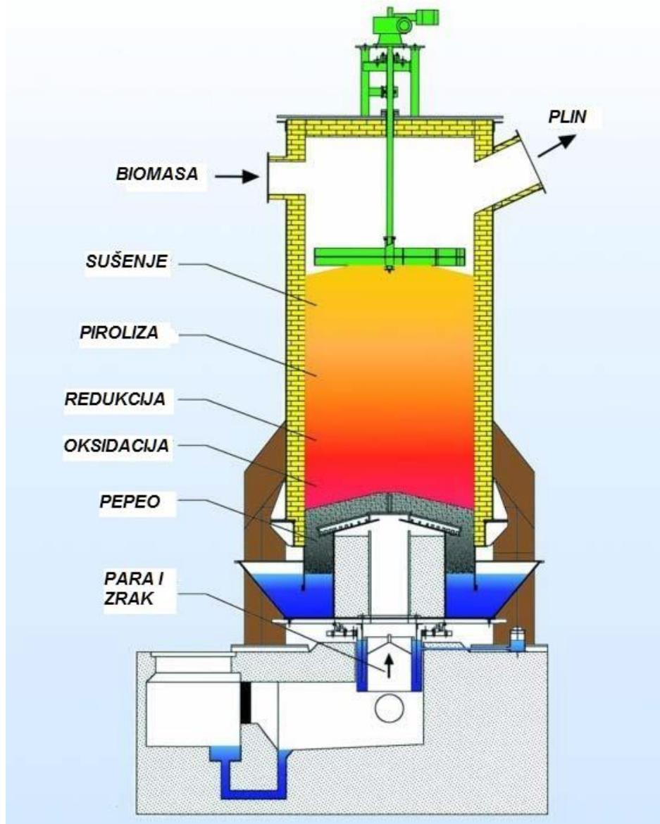
**Sl. 2.1.** Shema protustrujnog reaktora i faze procesa rasplinjavanja u nepokretnom sloju, prema [1]
