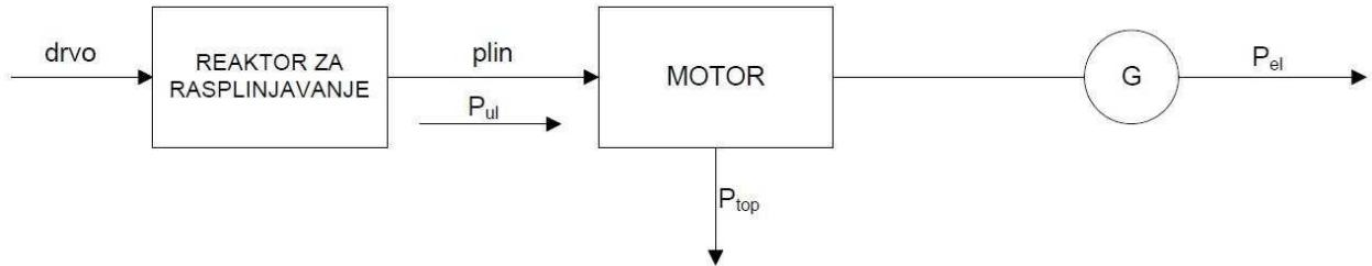
**Sl. 2.4.** Primjer sustava za proizvodnju električne energije rasplinjavanjem drvne biomase, prema [2]
