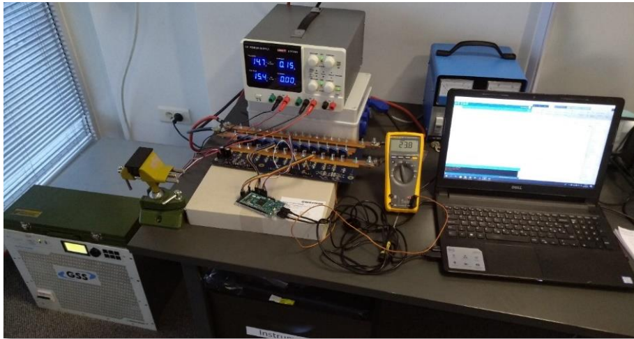
Slika 5.11. Eksperimentalni postav za validaciju metode upravljanja radnom temperaturom tranzistora
