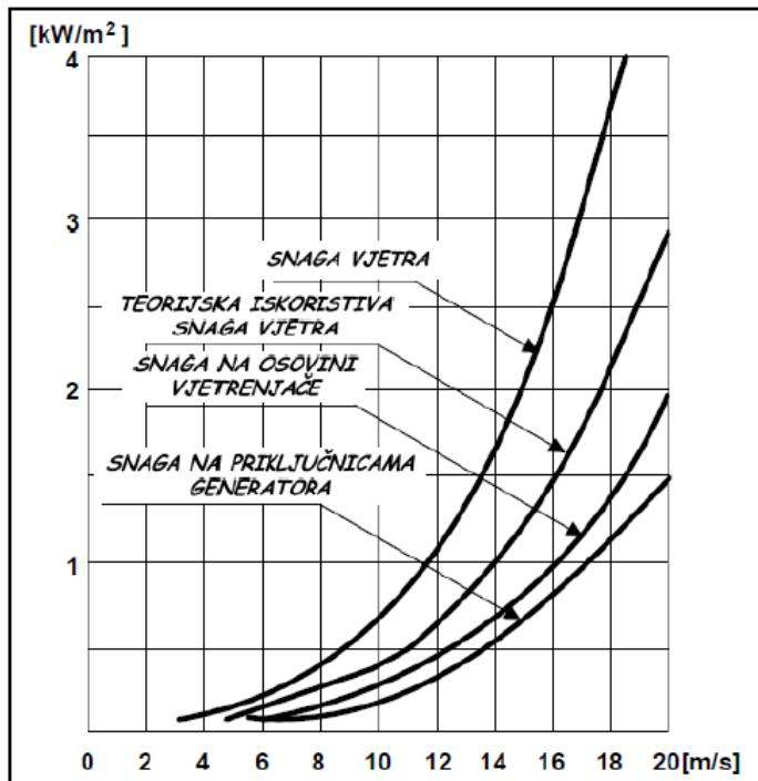
Slika 3.1. Ovisnost specifične snage  $[\text{kW}/\text{m}^2]$  o brzini vrtnje [17]
