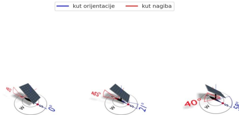
Slika 6.10. Jednoosni FN sustav s rotirajućom vertikalnom os
