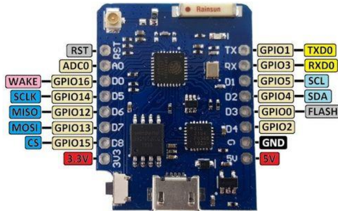
Sl. 3.2. Grafički priključci WeMos D1 Mini Pro razvojne pločice temeljene na ESP8266EX
