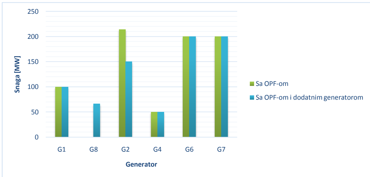
Slika 5.34: Izlazne snage generatora sa dodatnim generatorom na sabirnici 2
