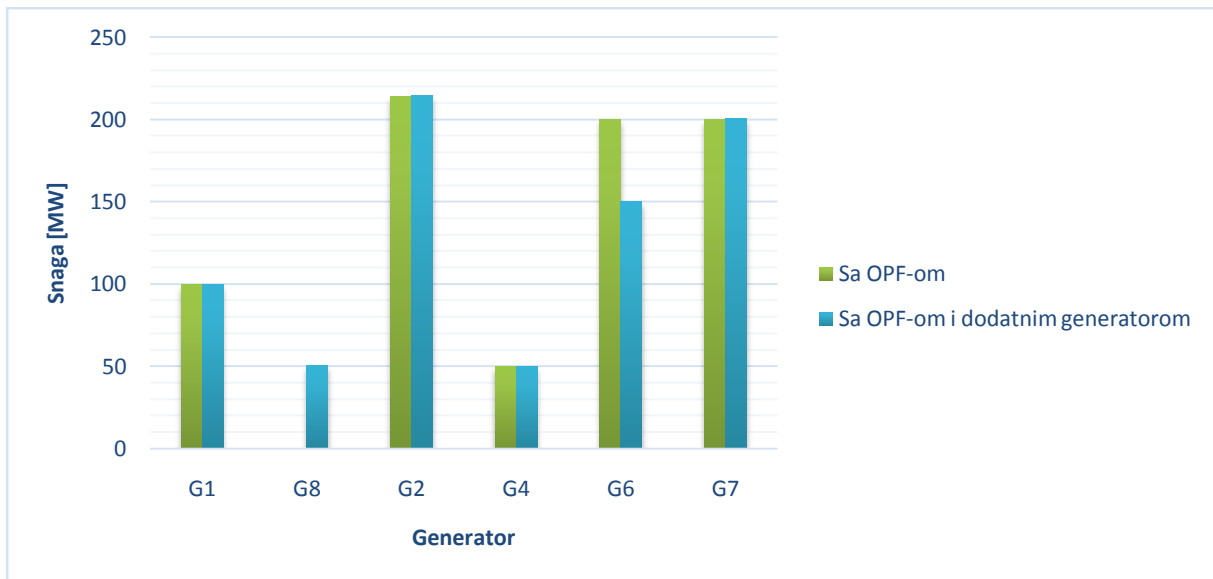
Slika 5.47: Izlazne snage generatora sa dodatnim generatorom na sabirnici 6
