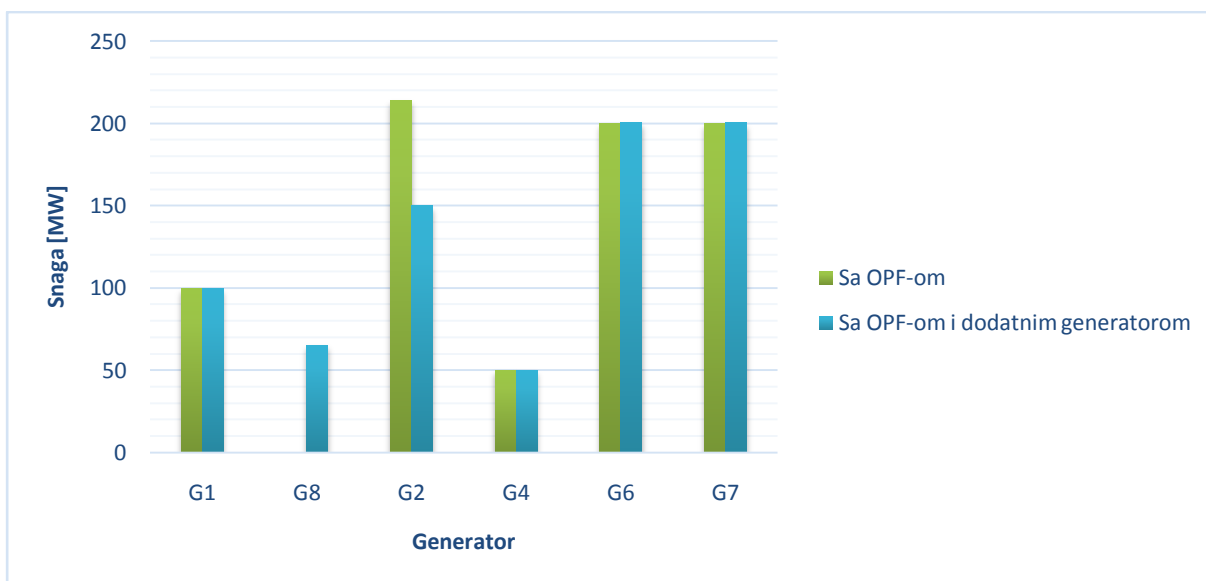
Slika 5.14: Izlazne snage generatora sa dodatnim generatorom na sabirnici 2
