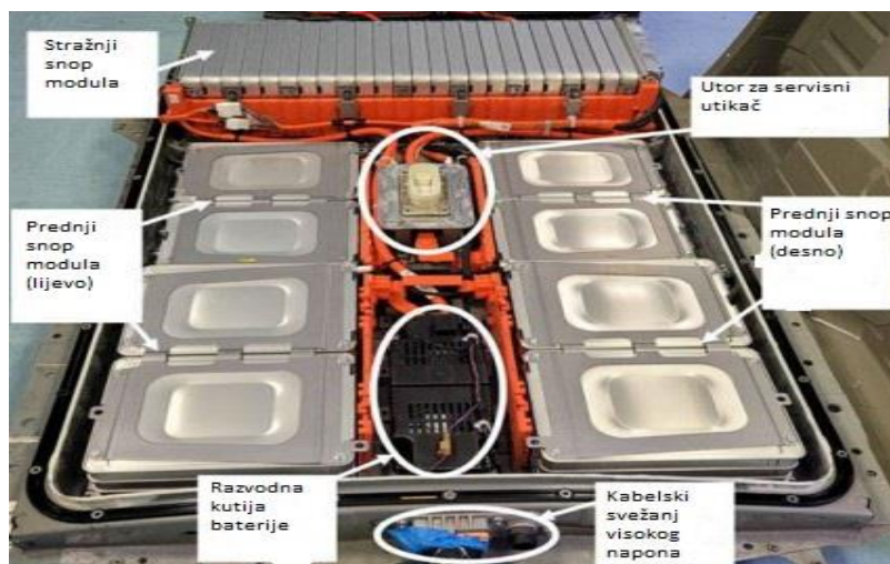
Slika 4.19. Prikaz komponenti baterije [35]
