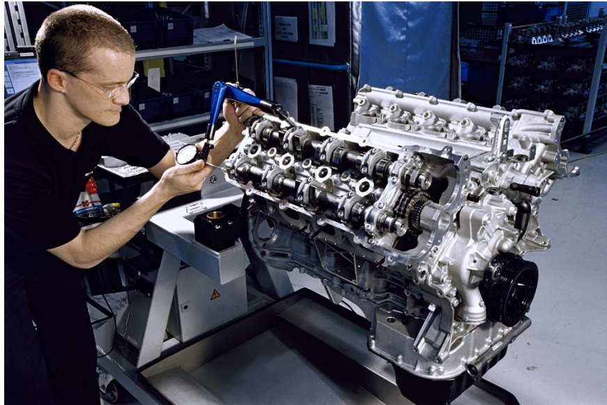
Slika 1.2. 6.3-litreni V8 ICE proizvođača AMG [3]
