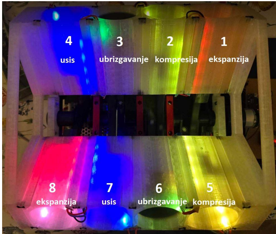
Slika 4.7. Prikaz zajedničkog rada klipova u cilindrima
