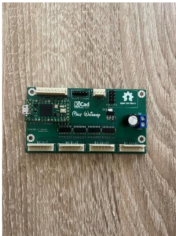
Slika 4.17. Tiskana pločica za zalemljenim konektorima
