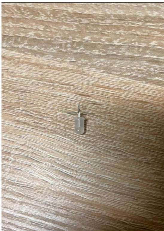
Slika 4.11. Izrezana LED dioda na mjeru
