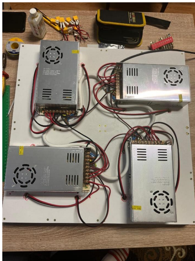
Slika 4.5. Napajanja spojena u zvijezda spoj
