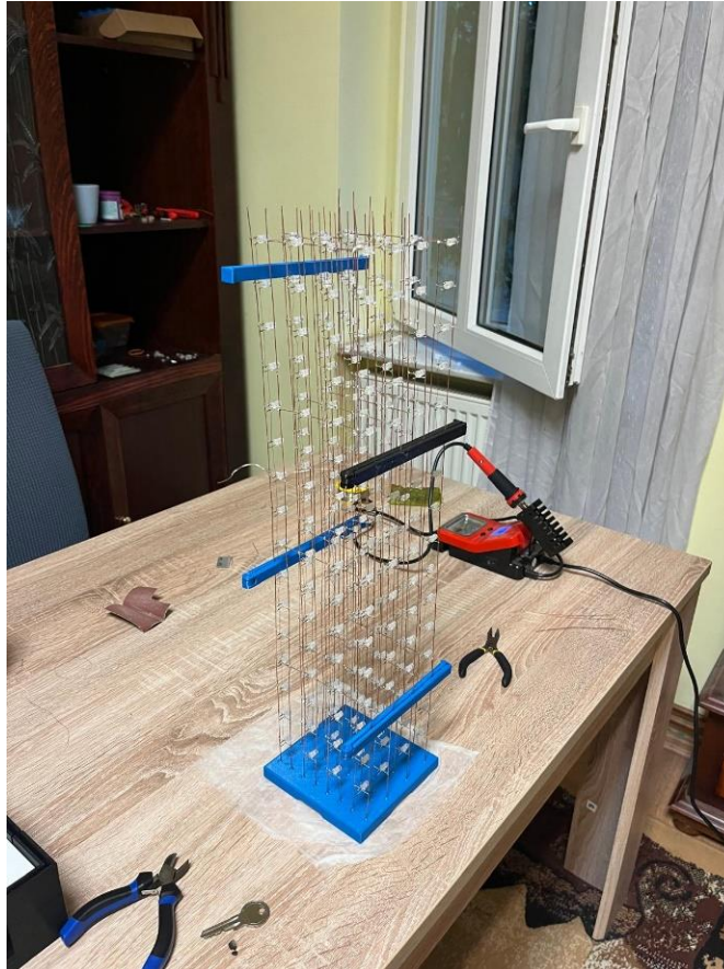
Slika 4.14. Toranj učvršćen kopčama
