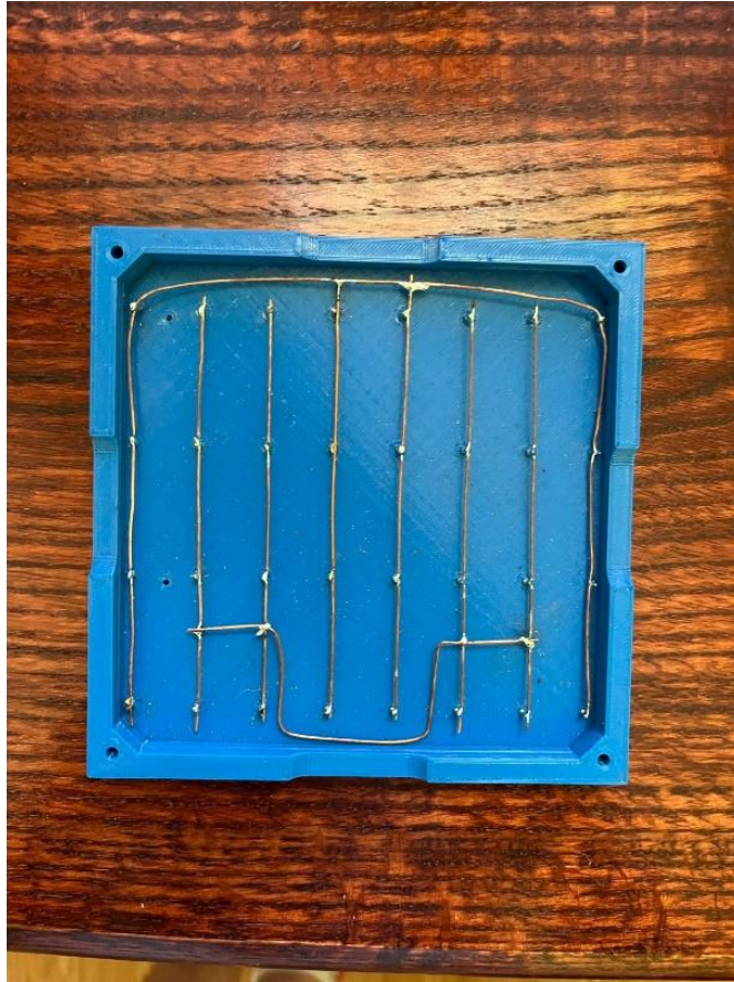
Slika 4.9. Prikaz spajanja vodova na PCB ploči
