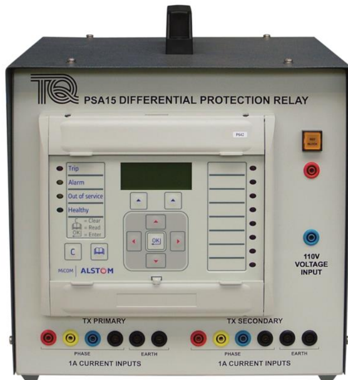
Slika 4.16. PSA15 diferencijalni relej [32]
