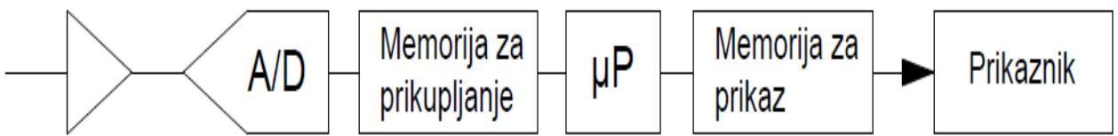
**Slika 3.8. Vrlo pojednostavljenja blok-shema klasičnog digitalnog osciloskopa (DSO)**
