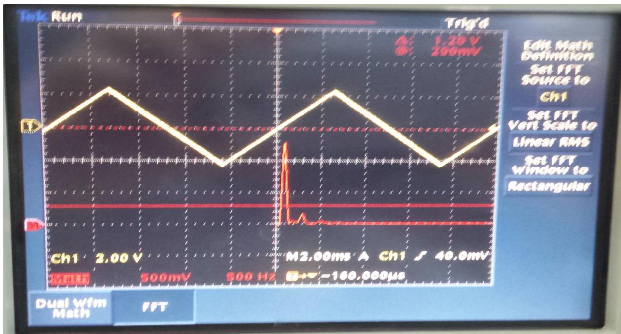
Slika 4.11. Frekvenčijska karakteristika pilastog signala
