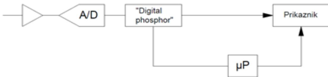
Slika 3.10. Vrlo pojednostavljenje blok-shema DPO osciloskopa
