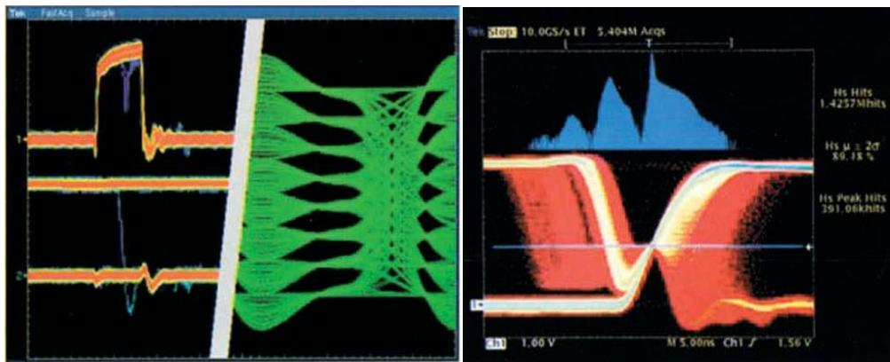
Slika 3.11. Primjeri prikaza na zaslonu DPO osciloskopa [6]
