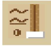
Slika 2.2. Uzemljenje, istosmjerna i izmjenična komponenta signala [1]
