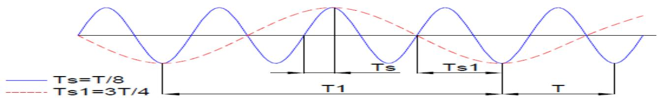
Slika 3.13. Uzrokovanje signala u stvarno vremenu (periode  $T$  označenog punom linijom), kod vremena uzorkovanja  $T_s$  nakon rekonstrukcije dobiva se originalni signal, a kod  $T_{s1}$  signal (označen crtanom linijom) s periodom  $T_1$  (nastaje pogreška zbog aliasinga)
