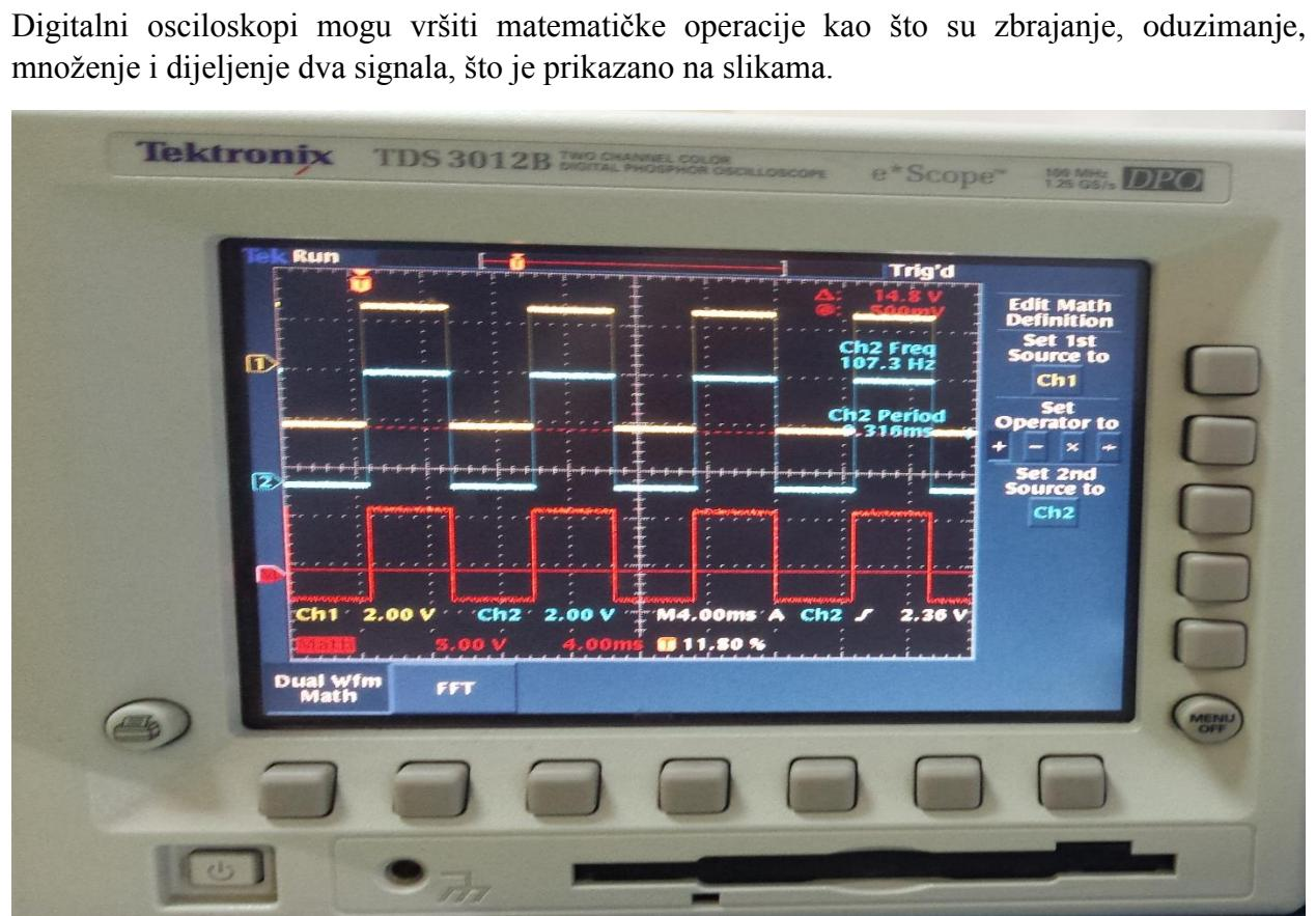
Slika 4.4. Zbrajanje dva signala digitalnim osciloskopom
