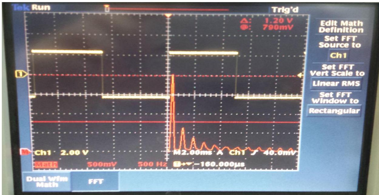
Slika 4.10. Frekvencijska karakteristika pravokutnog signala
