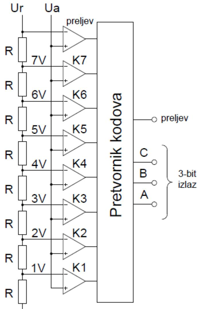
**Slika 3.7. Načelna shema paralelnog analogno-digitalnog pretvornika**
