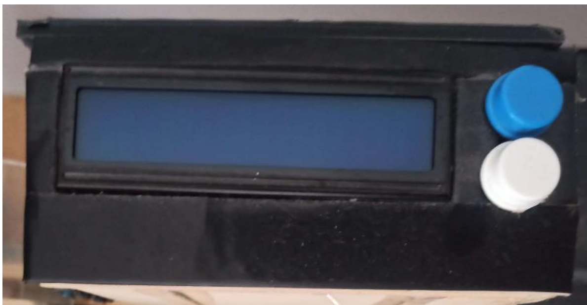
Slika 3.6. Tipkala i LCD ekran za prikaz informacija
