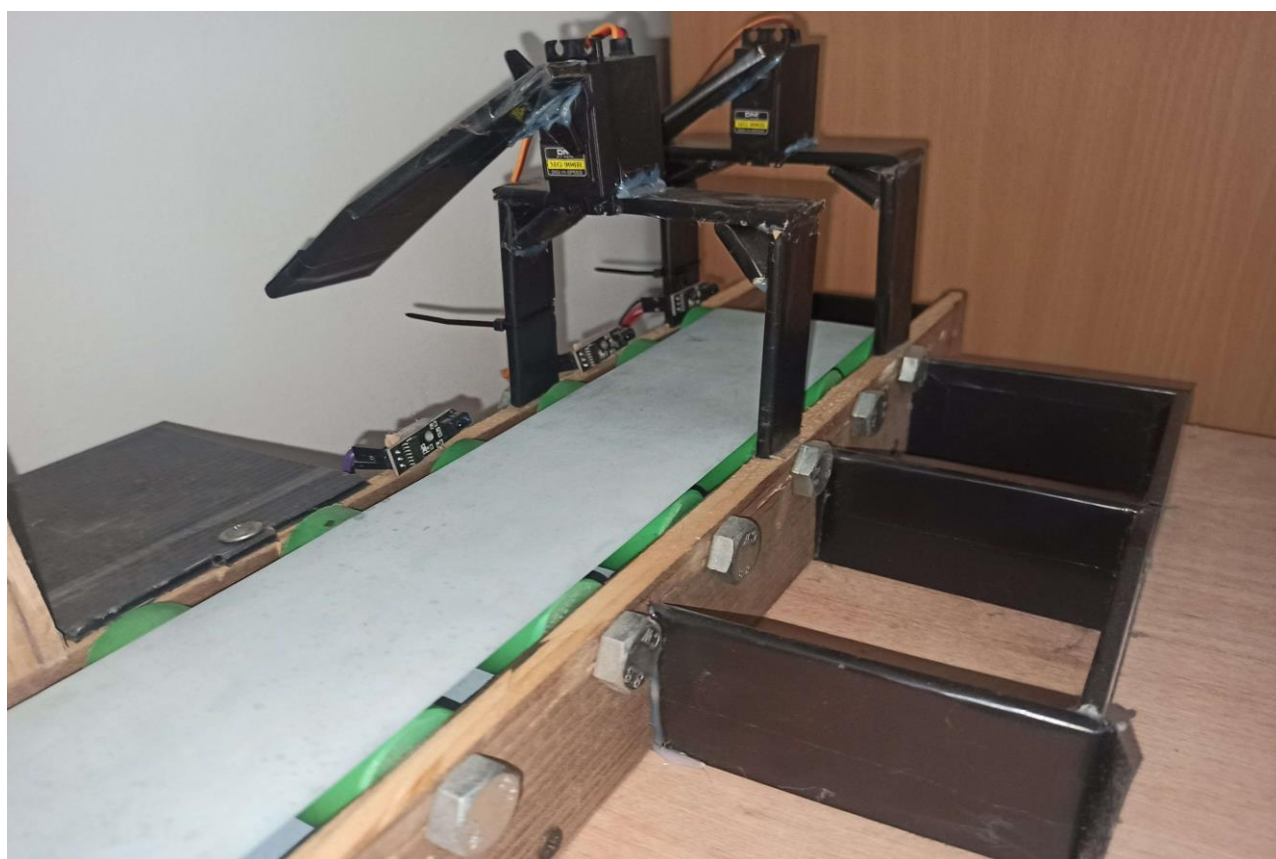
Slika 3.7. Stanice za propuštanje predmeta u predviđeni spremnik
